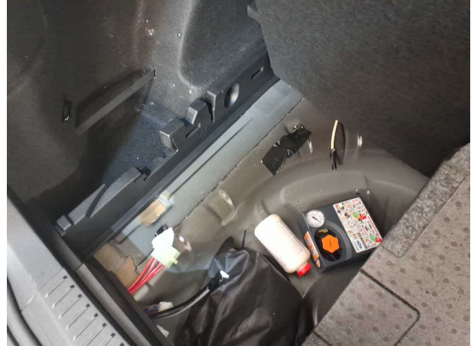
Damage 4: Electrical system: Cable strand (Kabelführung für Frontbereich im Laderaum) - Specify findings - Replace
