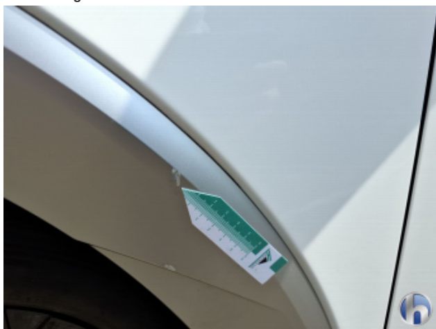
5. Radlaufblende li.vo. Kratzer - Smart Repair
