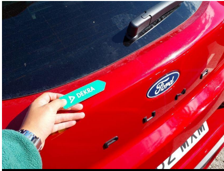
Portón trasero / puerta del maletero / - / Abolladura
