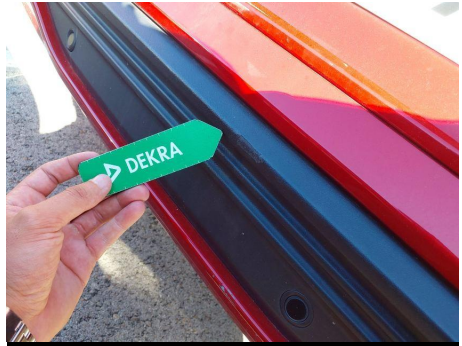
Moldura de paragolpes / Trasero / Ralladura
