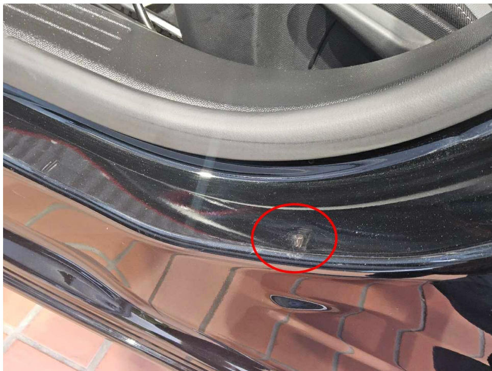
Bild 14 : Einstieg vorne links Delle/Kratzer
