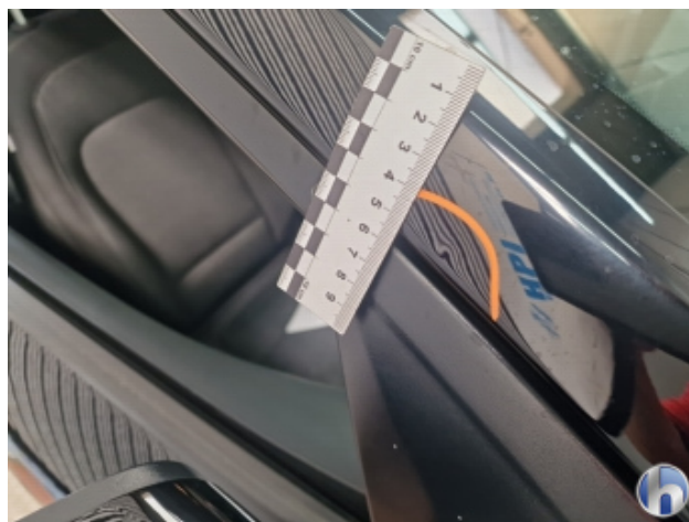
2. A-Säule Vorne - Rechts Delle - Sanft Instandsetzen
