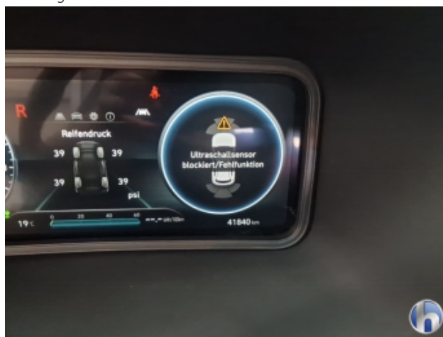
1. Parksensor Hinten Beschädigt - Erneuern
