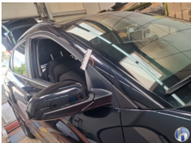
2. A-Säule Vorne - Rechts Delle - Sanft Instandsetzen
