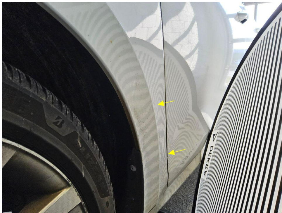
Bild 25 : Kotflügel vorne links eingedellt und verformt
