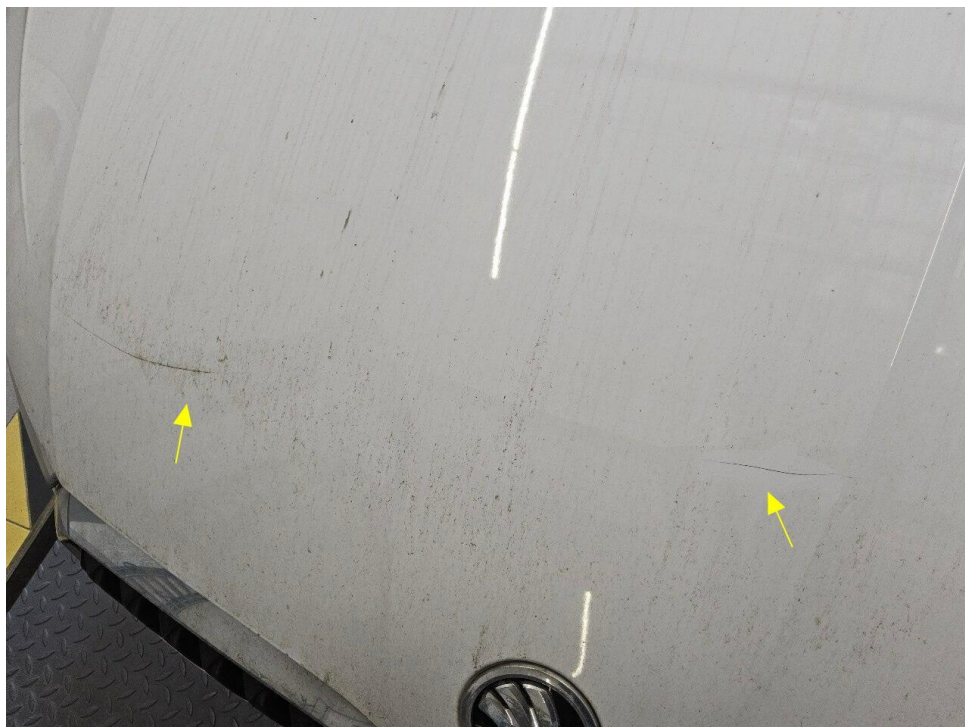
Bild 16 : Motorhaube deformiert und verkratzt
