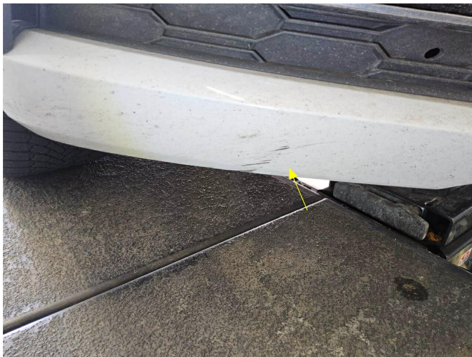
Bild 21 : Stoßfänger vorne verkratzt
