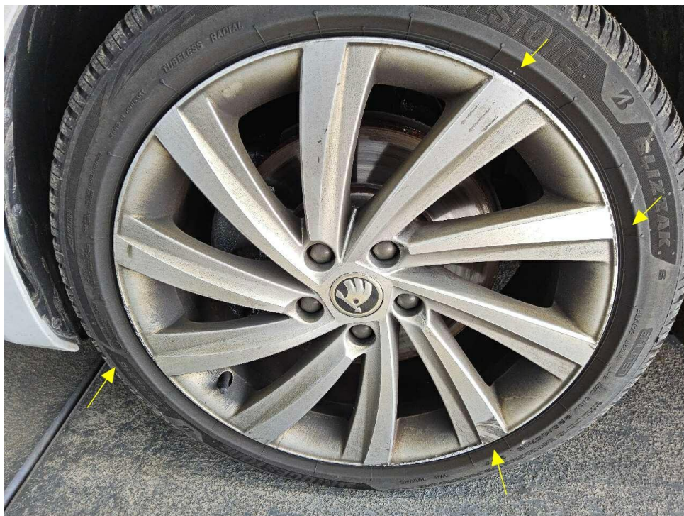
Bild 8 : Leichtmetallfelge vorne links verschrammt, Minderwert
