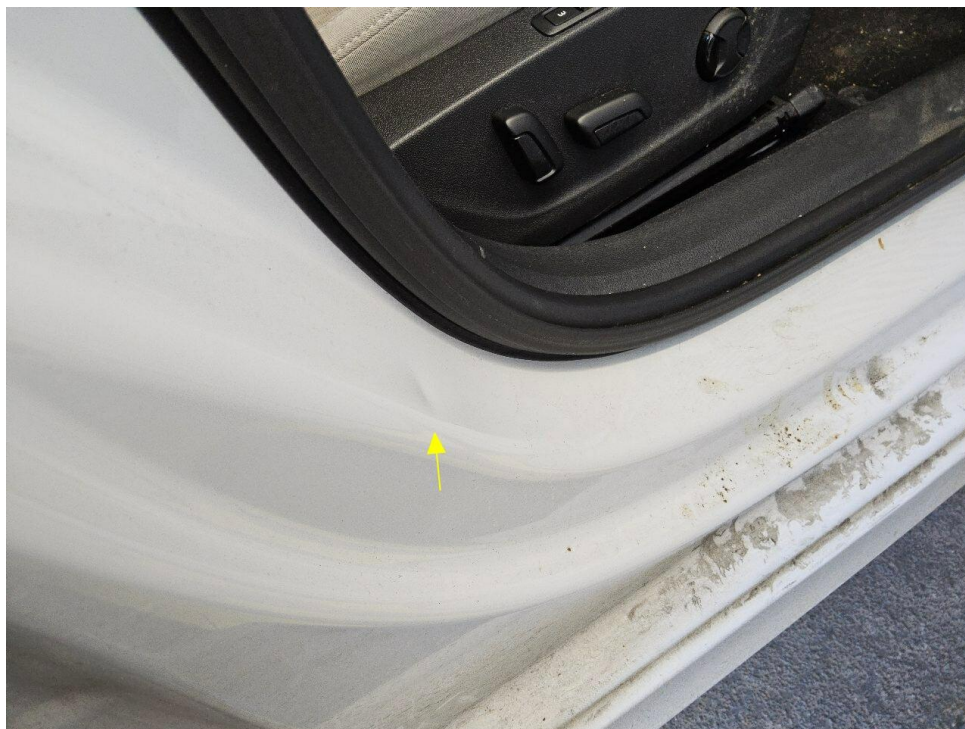
Bild 19 : Einstieg vorn rechts eingedellt
