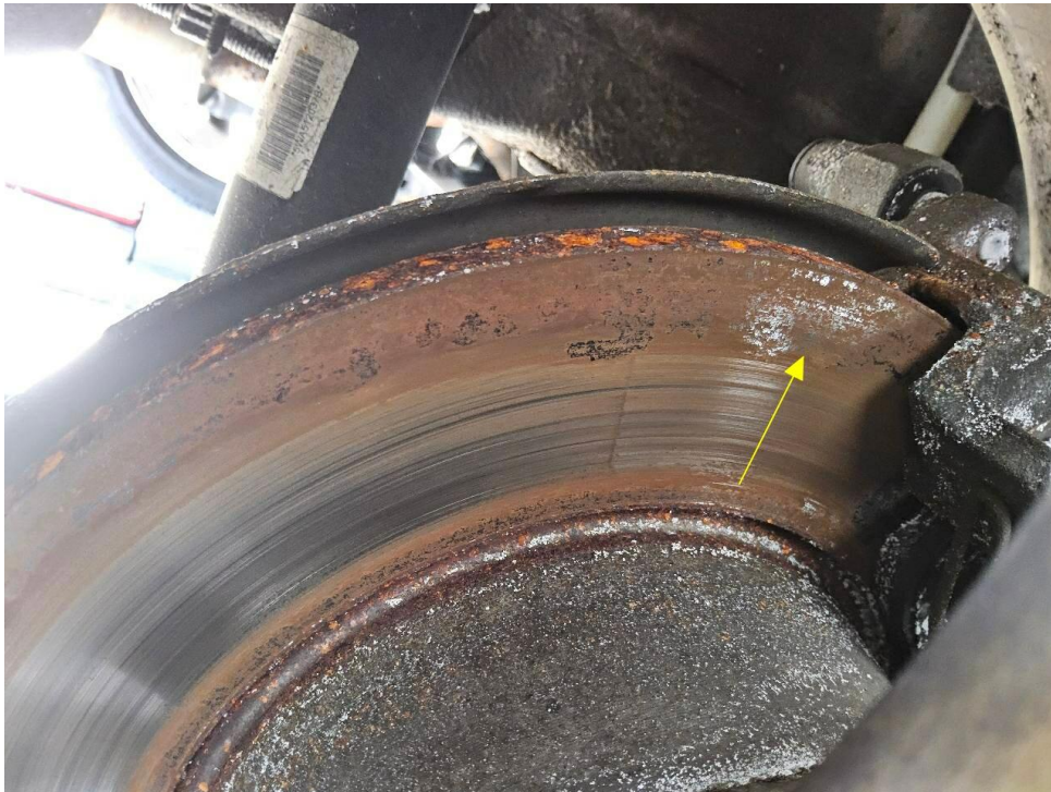
Bild 23 : Bremsscheiben Hinterachse und Vorderachse Tragbild mangelhaft
