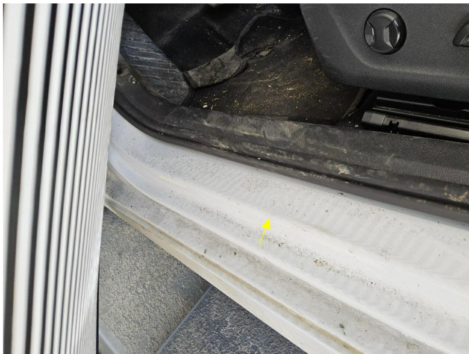
Bild 7 : Tür vorne links Einstieg, deformiert, smart repair
