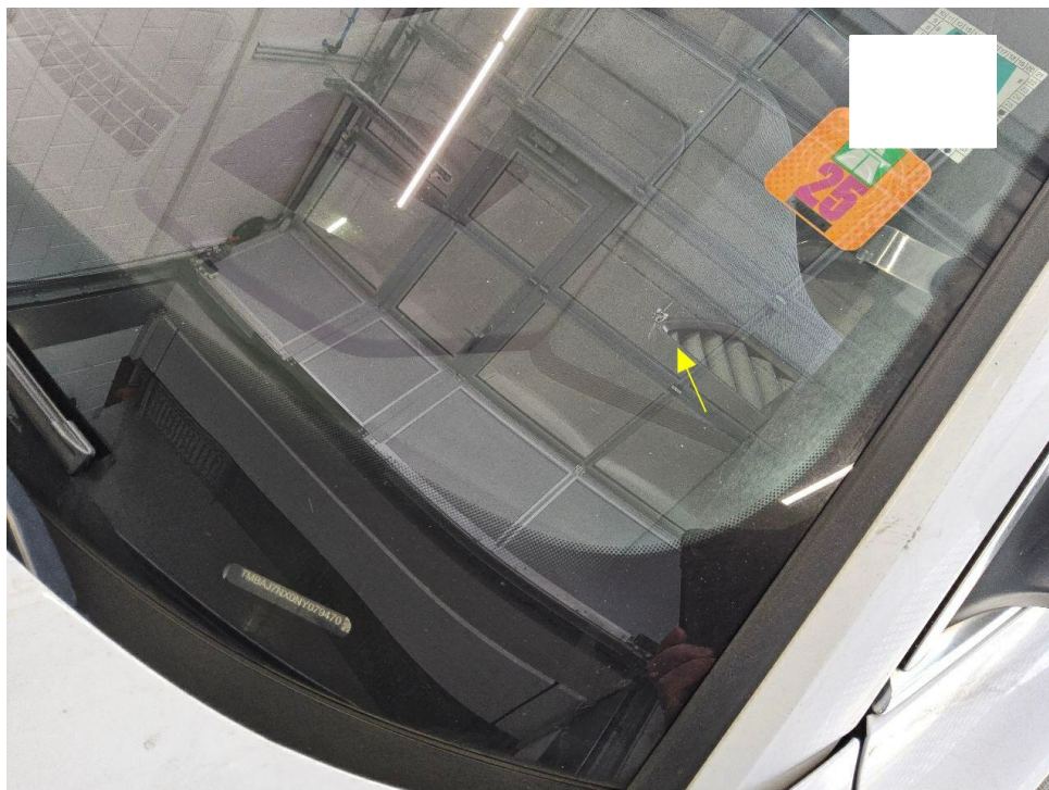
Bild 14 : Windschutzscheibe Steinschlag mit Rissbildung
