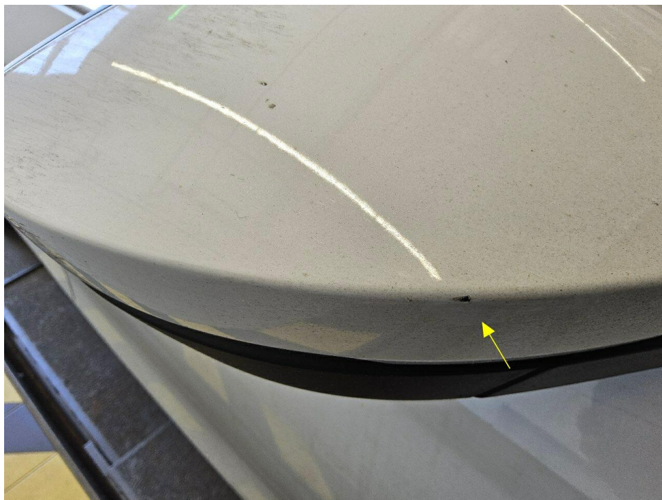
Bild 17 : Spiegelkappe rechts zerkratzt
