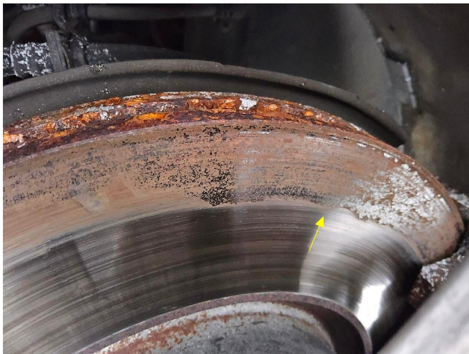
Bild 22 : Bremsscheiben Hinterachse und Vorderachse Tragbild mangelhaft
