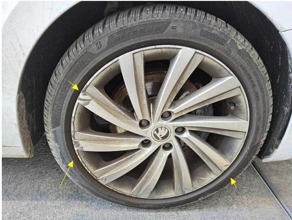
Bild 9 : Leichtmetallfelge vorne rechts verschrammt, Minderwert
