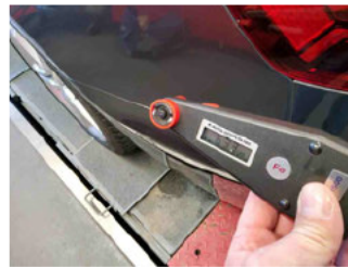
Lackstärke Seitenwand hinten links
