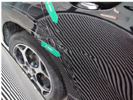
Tür / Hinten Rechts / Delle
