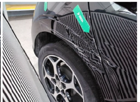
Kotflügel / Hinten Rechts / Delle
