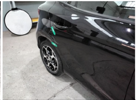
Tür / Hinten Rechts / Delle
