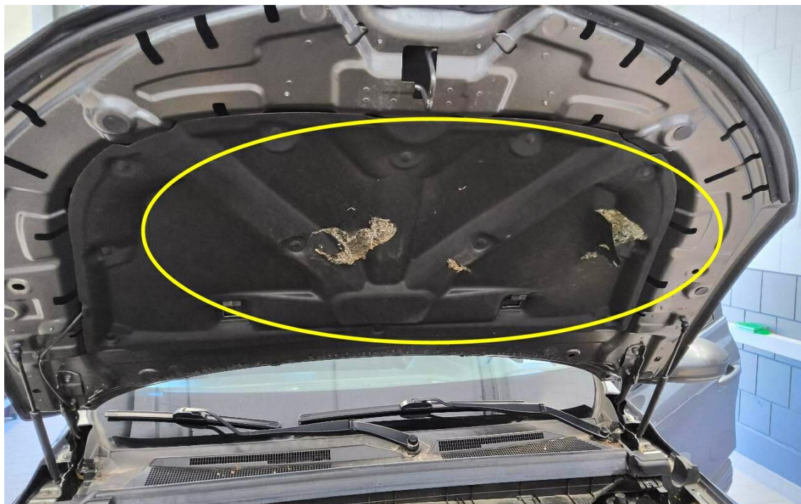
Bild 19 : Motorraum, Dämmungen, gerissen
