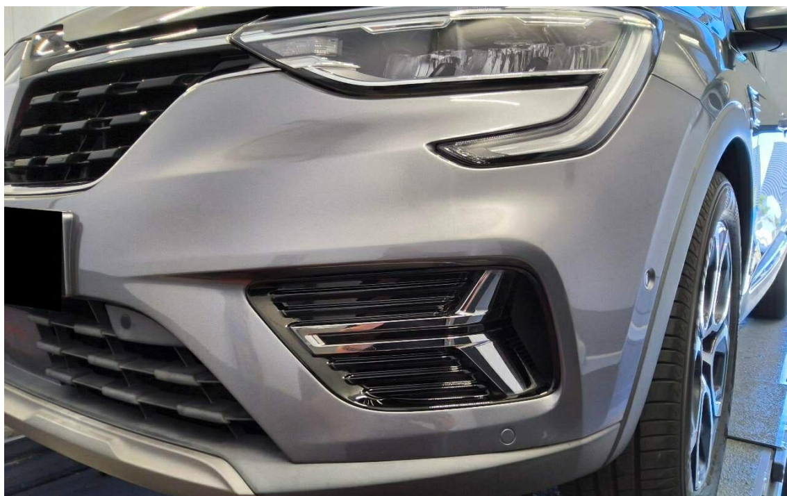
Bild 18 : Stoßfänger vorn, Steinschläge
