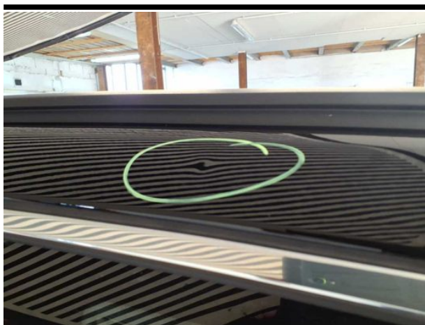
Beschädigung #4: Fahrzeugdach: Dachholm links - Delle(n) - sanft instandsetzen
