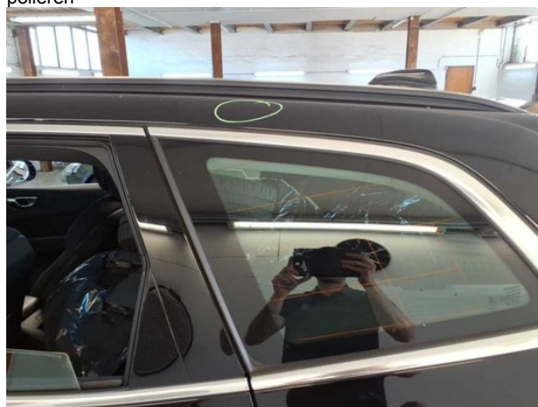
Beschädigung #4: Fahrzeugdach: Dachholm links - Delle(n) - sanft instandsetzen
