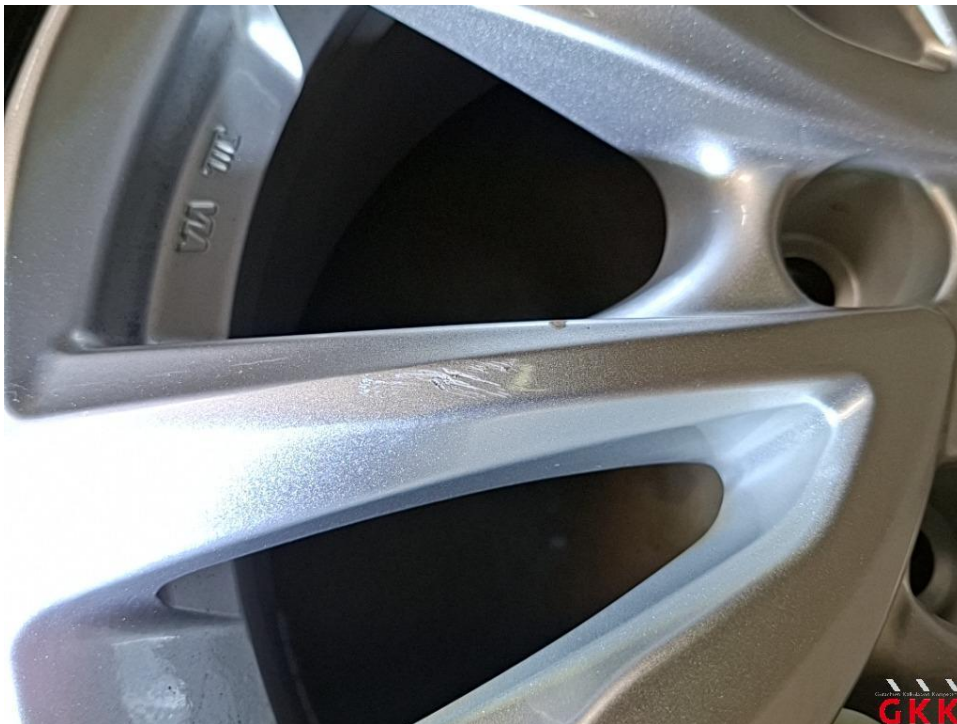
Bild 17 LM-Rad, 1 x beiliegend, verkratzt, aufbereiten
