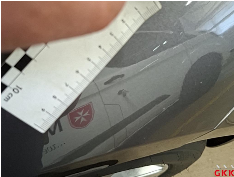
Bild 22 Kotflügel vorne rechts, Steinschlag, lackieren
