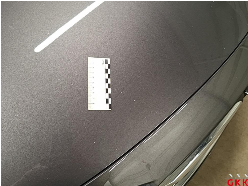
Bild 18 Motorhaube, Steinschlag, lackieren
