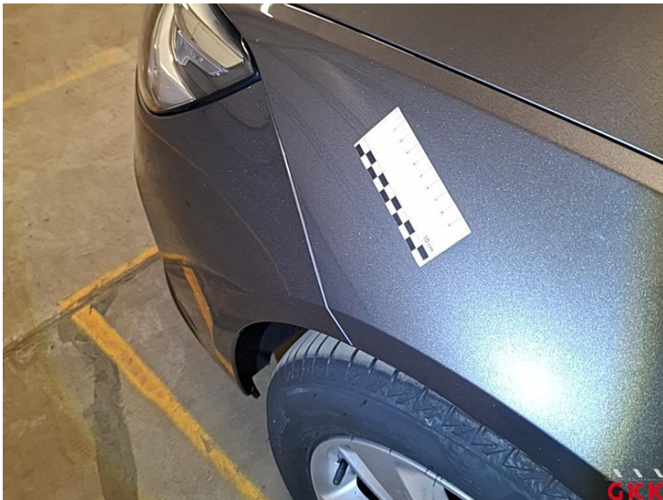
Bild 23 Kotflügel vorne links, Steinschlag, lackieren
