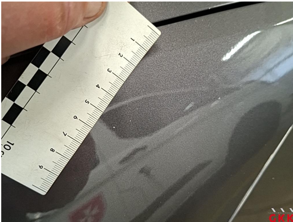
Bild 21 Kotflügel vorne rechts, Steinschlag, lackieren
