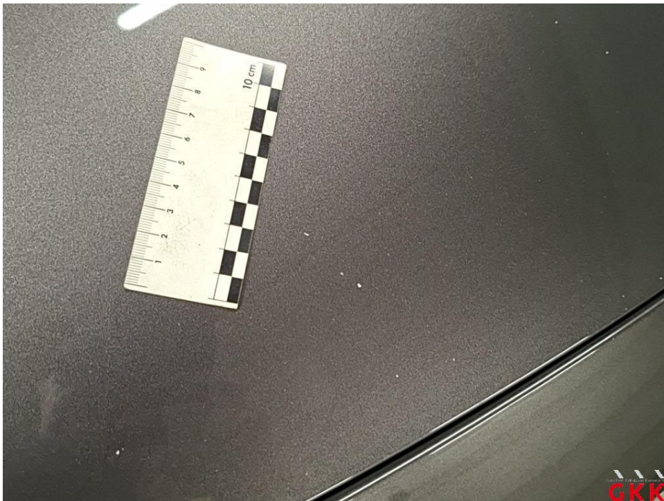
Bild 19 Motorhaube, Steinschlag, lackieren
