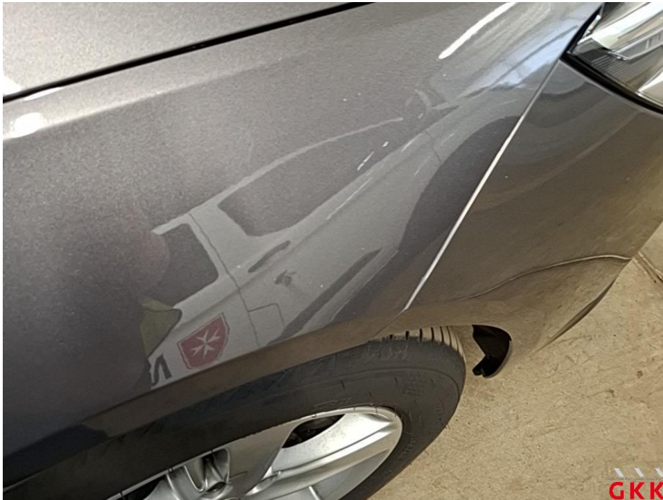
Bild 20 Kotflügel vorne rechts, Steinschlag, lackieren
