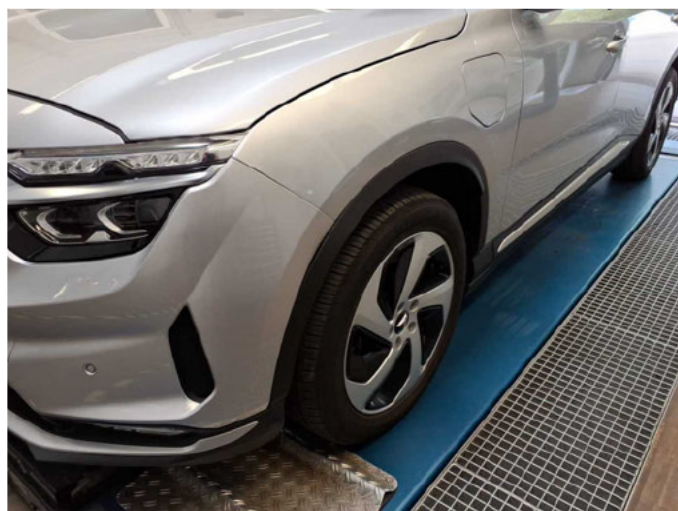
Beschädigung 2: Kotflügel links: Radhausverbreiterung - Fehlstellung - instandsetzen
