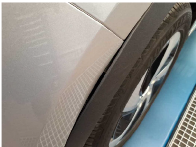
Beschädigung 2: Kotflügel links: Radhausverbreiterung - Fehlstellung - instandsetzen
