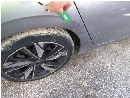
Aleta / Trasero Derecho / Abolladura
