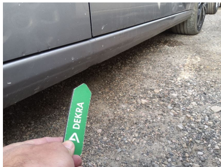
Estribo / Delantero Derecho / Abolladura
