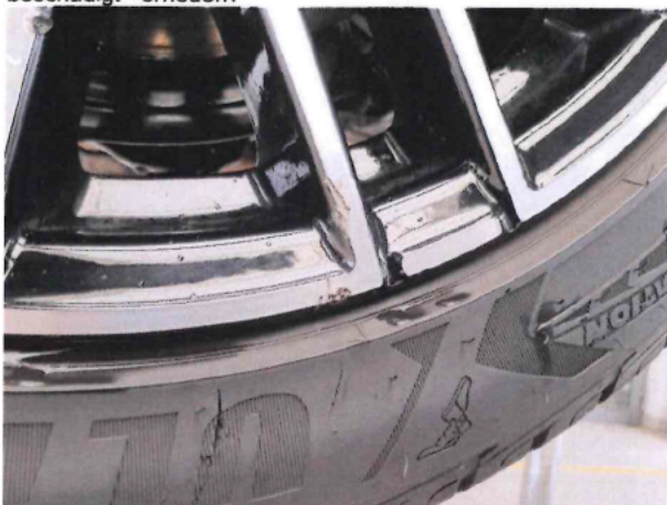
Beschädigung #7: Rad/Reifen: Leichtmetallfelge hinten rechts - beschädigt - erneuern
