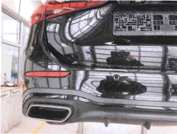
Beschädigung #5: Stossfänger hinten: Stossfänger hinten (Ladekante) - Kratzer - Smart Repair
