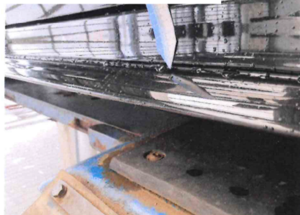
Beschädigung #8: Schweller rechts: Verkleidung - verkratzt / verschürft - erneuern
