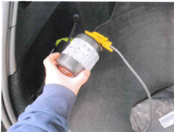
Beschädigung #1: Ausrüstung: Trefit Füllmittel (Benutzt) - abweichend Auslieferungszustand - erneuern
