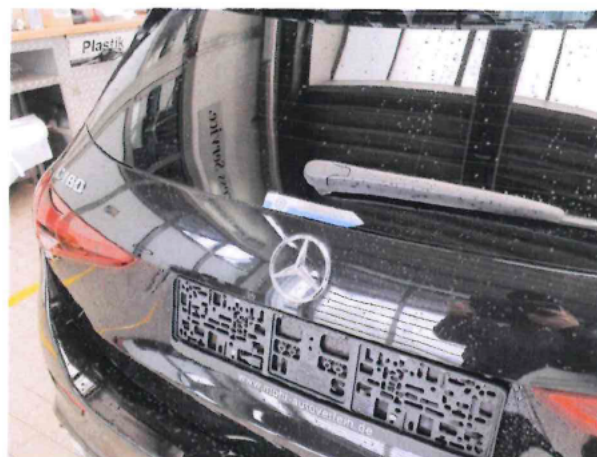
Beschädigung #3: Heckklappe/-tür: Heckklappe - Delle(n) - sanft instandsetzen
