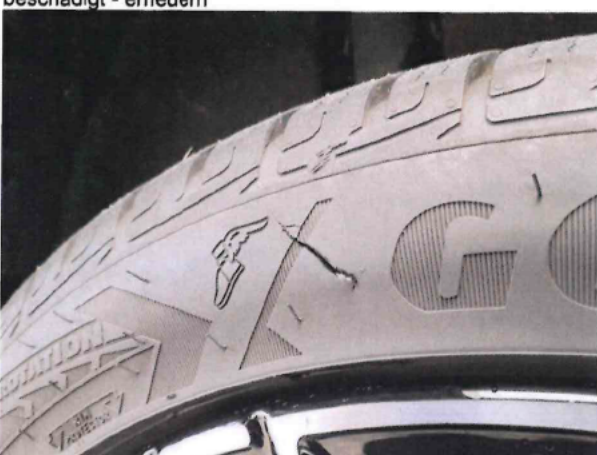
Beschädigung #4: Rad/Reifen: Reifen hinten rechts - beschädigt - erneuern
