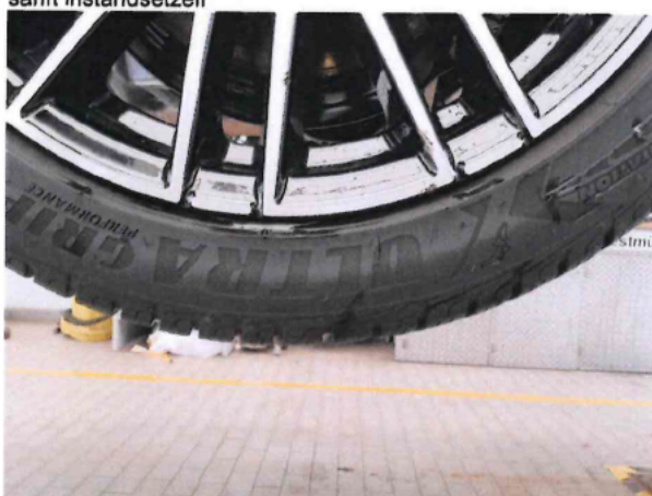
Beschädigung #4: Rad/Reifen: Reifen hinten rechts - beschädigt - erneuern
