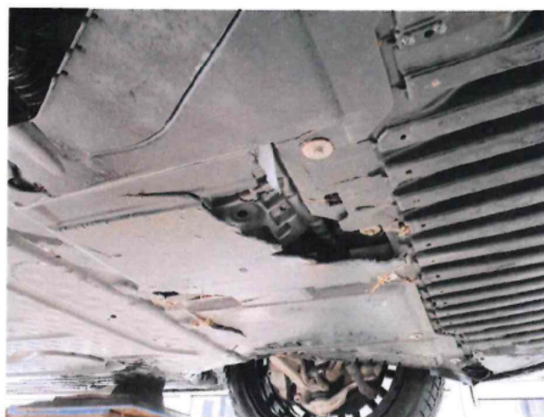
Beschädigung #9: Karosserie: Karosserie (Front-/ Unterbodenschaden, mehrkosten möglich, KV notwendig) -
