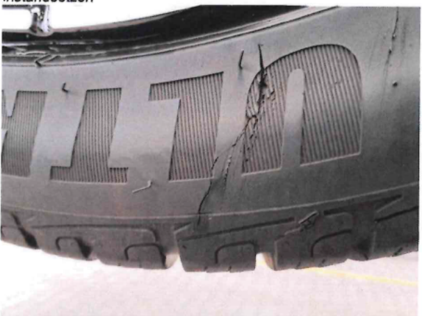
Beschädigung #4: Rad/Reifen: Reifen hinten rechts - beschädigt - erneuern
