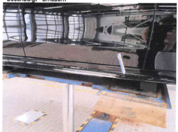
Beschädigung #8: Schweller rechts: Verkleidung - verkratzt / verschürft - erneuern
