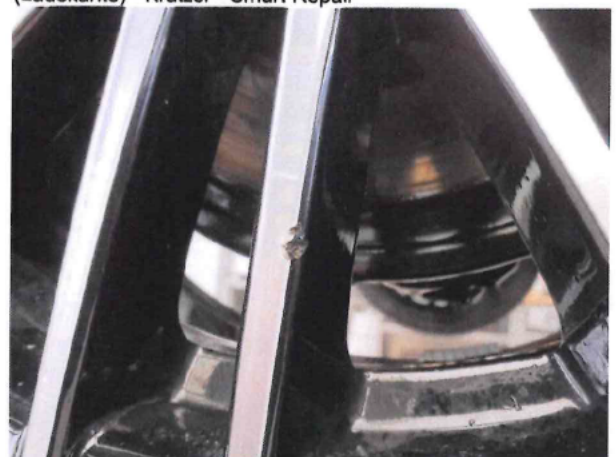
Beschädigung #7: Rad/Reifen: Leichtmetallfelge hinten rechts - beschädigt - erneuern
