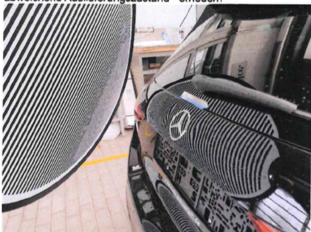
Beschädigung #3: Heckklappe/-tür: Heckklappe - Delle(n) - sanft instandsetzen
