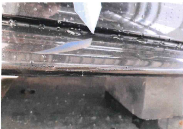
Beschädigung #8: Schweller rechts: Verkleidung - verkratzt / verschürft - erneuern
