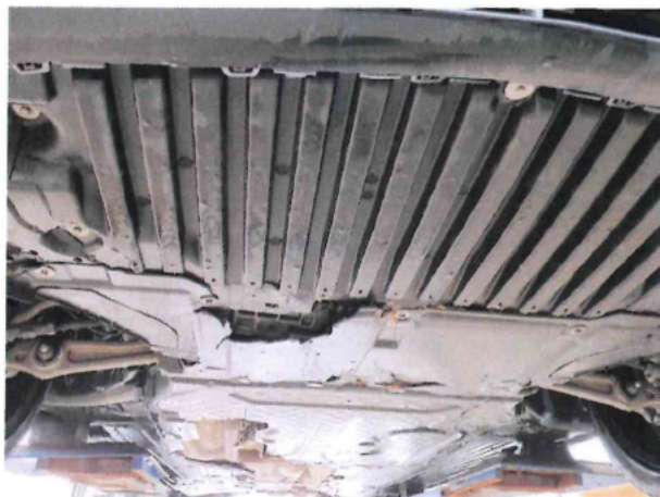
Beschädigung #9: Karosserie: Karosserie (Front-/ Unterbodenschaden, mehrkosten möglich, KV notwendig) -
