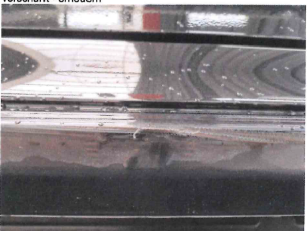
Beschädigung #8: Schweller rechts: Verkleidung - verkratzt / verschürft - erneuern
