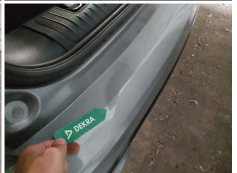
Paragolpes / Trasero / Abolladura
