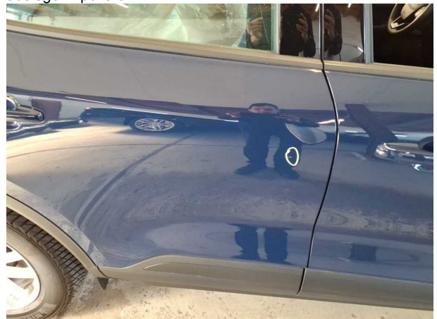
Beschädigung #6: Tür hinten rechts: Tür - Delle / Lackschad... - instandsetzen und lackieren
