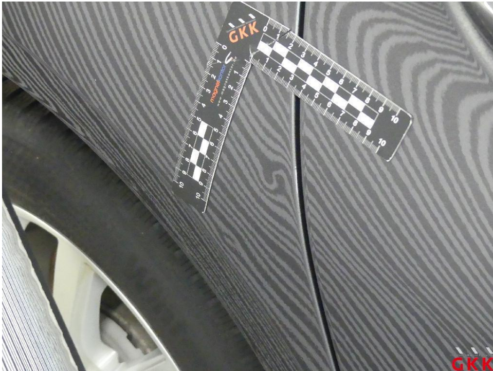
Bild 25 Seitenwand rechts, beschädigt, instand setzen - lackieren
