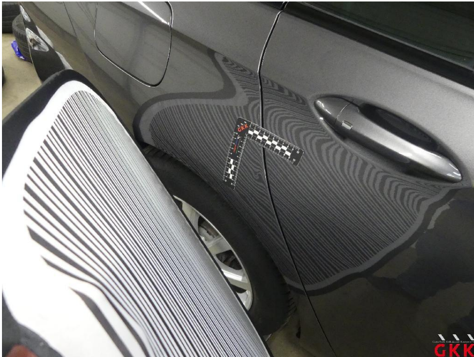
Bild 23 Seitenwand rechts, beschädigt, instand setzen - lackieren
