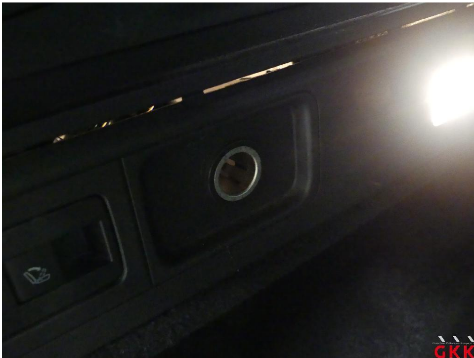
Bild 28 Laderaum, Steckdose -Abdeckung-, fehlt, ersetzen
