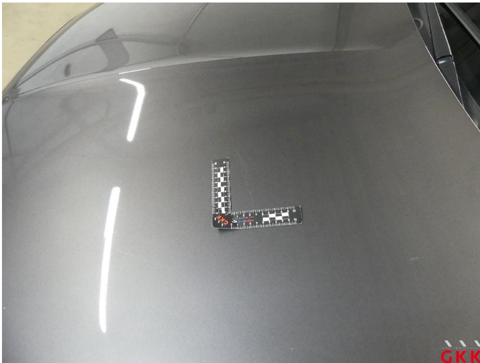
Bild 18 Motorhaube, verkratzt, lackieren
