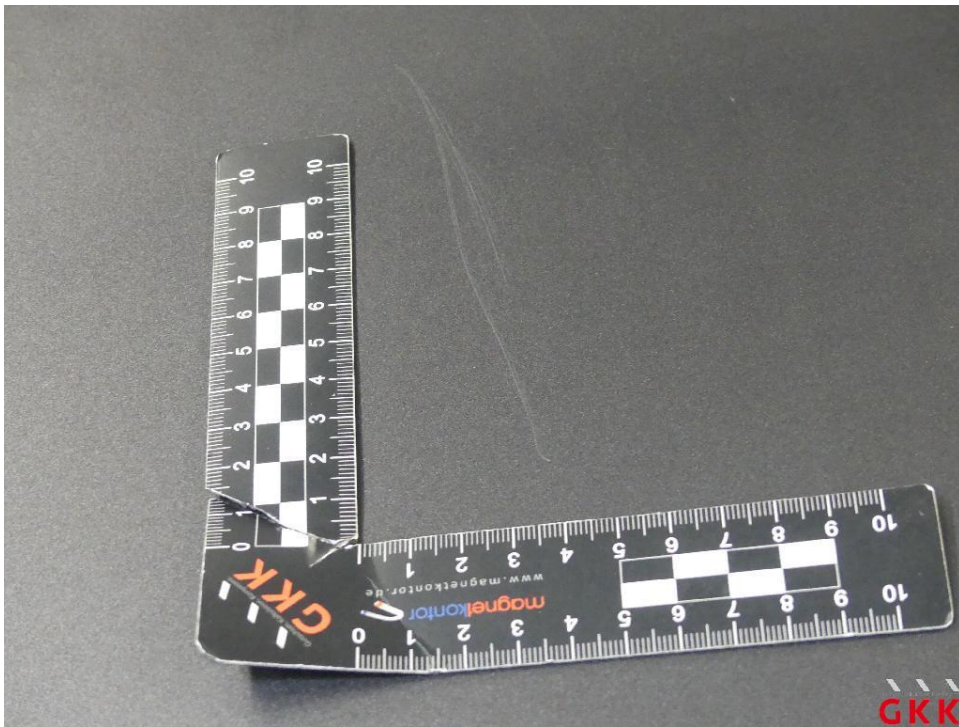
Bild 20 Motorhaube, verkratzt, lackieren
