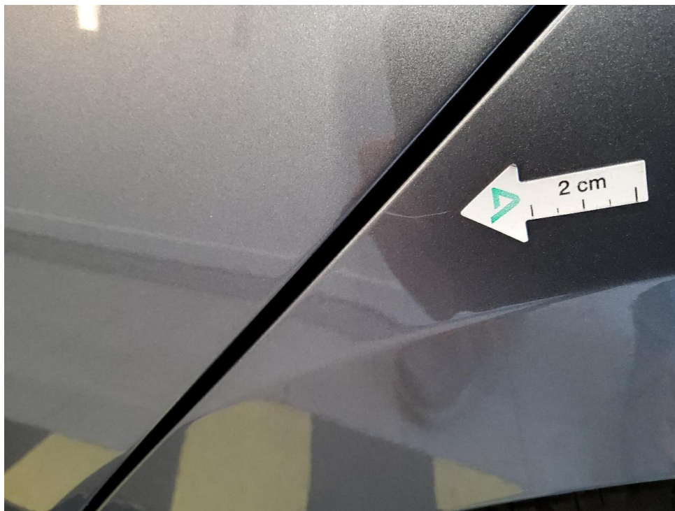
Bild 16 : Seitenwand hinten links zerkratzt
