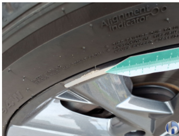
1. Felge Vorne - Links Kratzer - Smart Repair
