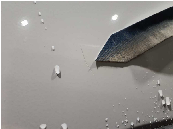
Beschädigung #1: Tür vorn rechts: Tür - verkratzt / verschürft - lackieren
