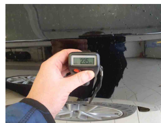
Lackstärke Seitenwand hinten links
