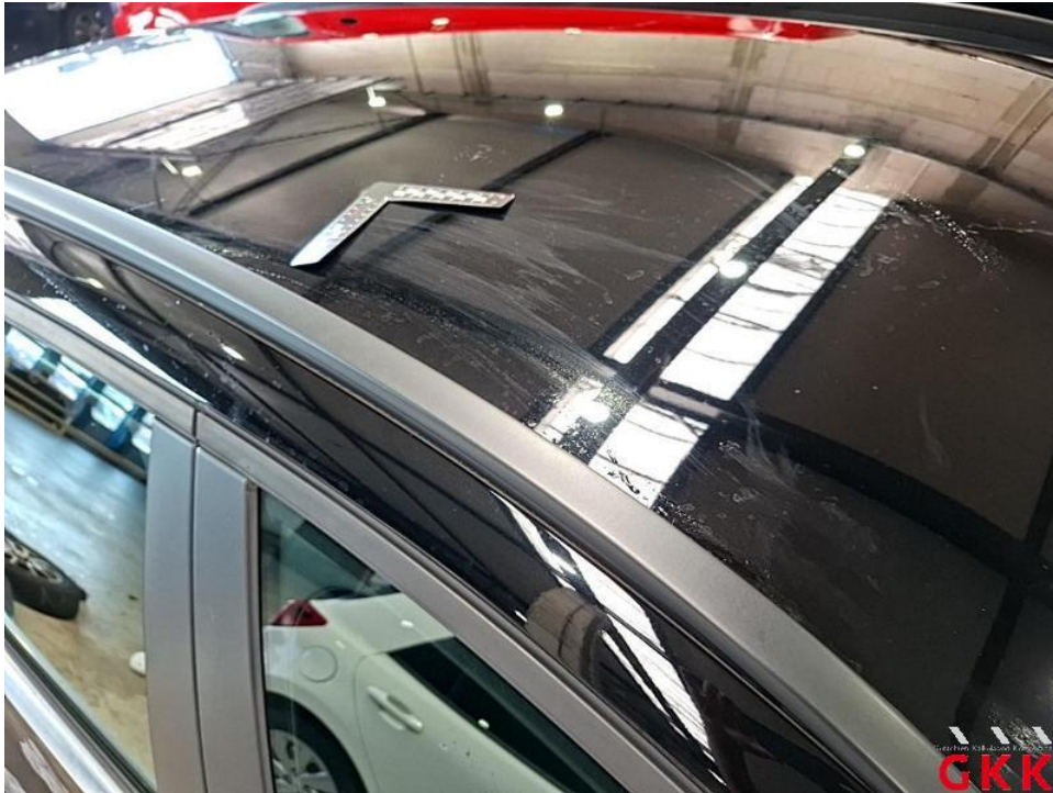
Bild 49. Dach, Lackierung verätzt, lackieren
