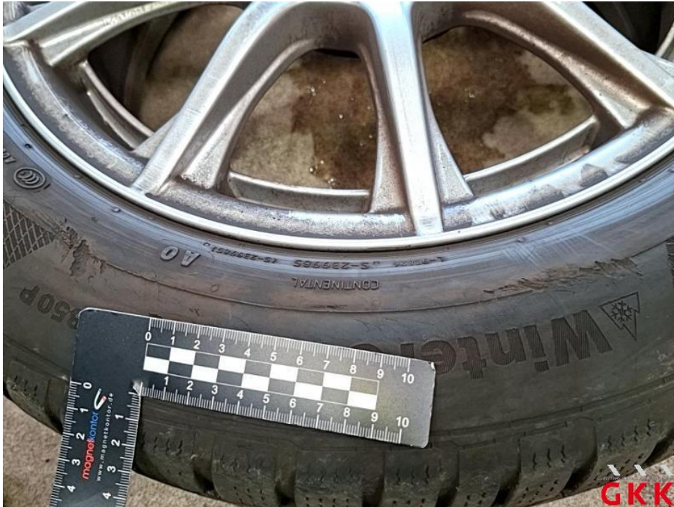
Bild 59. Reifen, 1 x beiliegend, beschädigt, ersetzen
