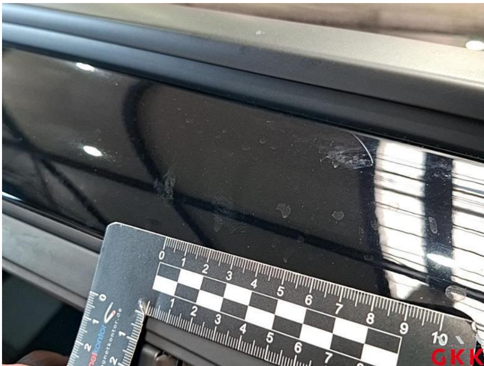
Bild 48. Dach, Holm rechts, verkratzt, auslegen, schleifen, polieren
