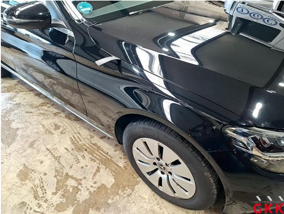
Bild 55. Kotflügel vorne rechts, verkratzt, lackieren
