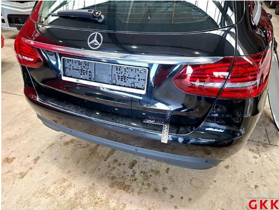
Bild 39. Stoßfänger hinten, Verkleidung -lackiert-, verkratzt, lackieren
