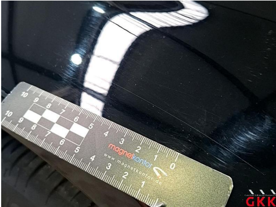
Bild 57. Kotflügel vorne rechts, verkratzt, lackieren
