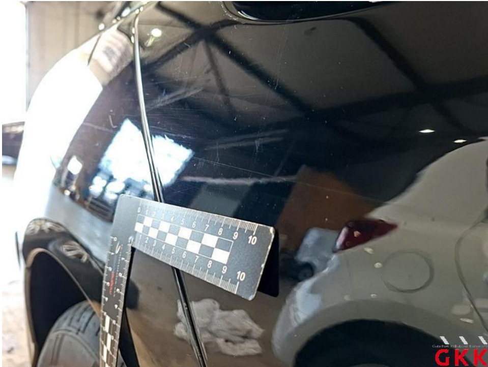
Bild 53. Tür hinten rechts, Reparaturmangel, aufbereiten
