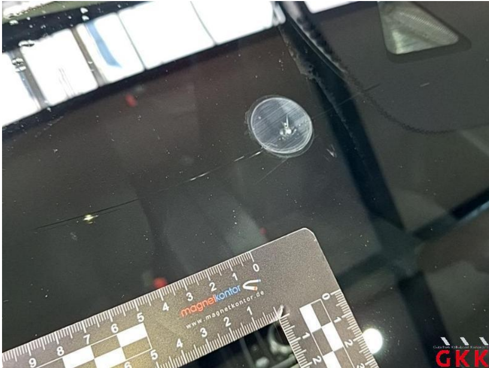
Bild 19. Frontscheibe, mit Regensensor und Frontkamera, gerissen, ersetzen
