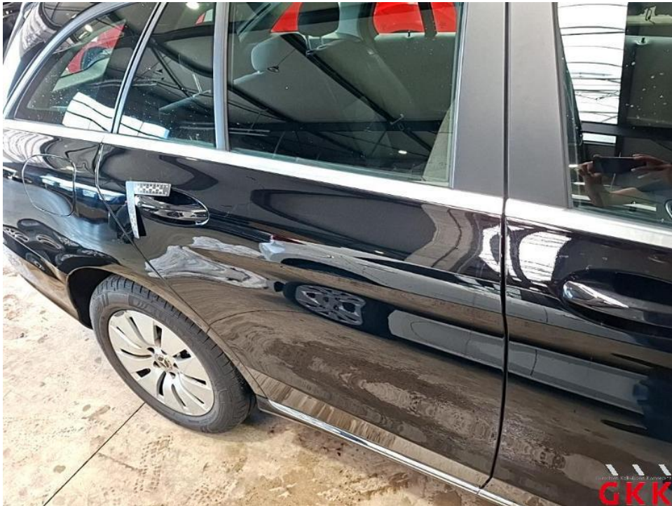
Bild 52. Tür hinten rechts, Reparaturmangel, aufbereiten
