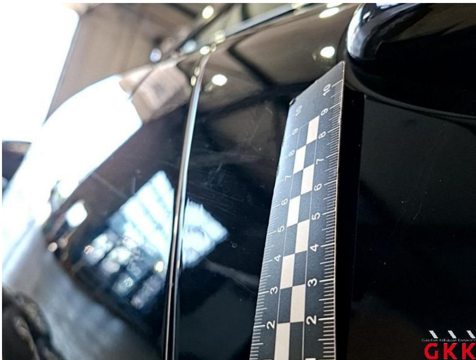
Bild 54. Tür hinten rechts, Reparaturmangel, aufbereiten
