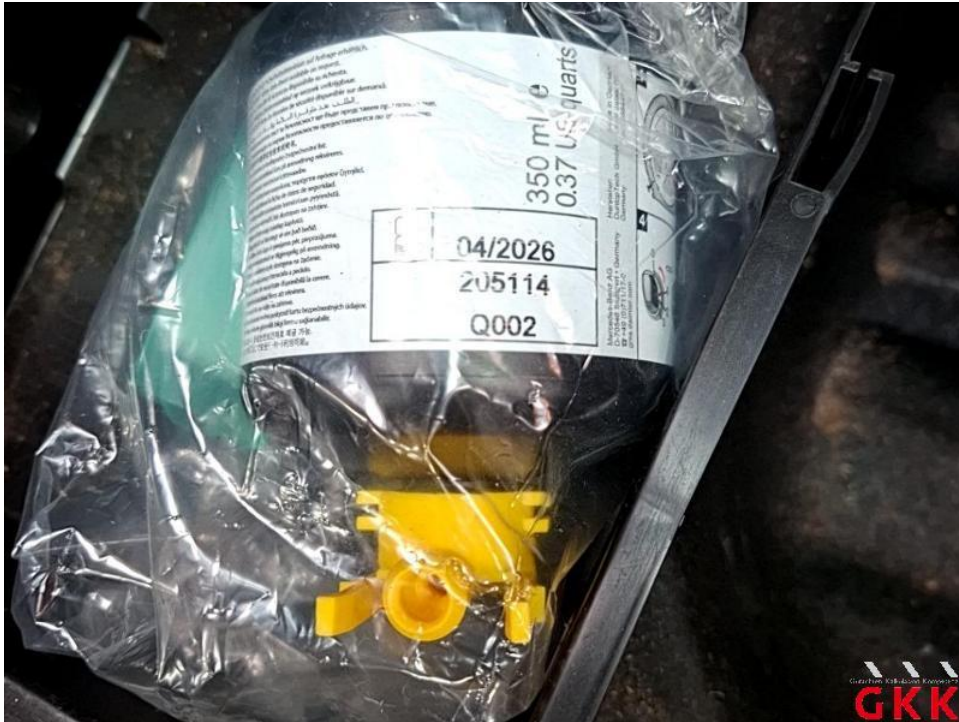
Bild 13. Reifenreparaturset, Füllflasche, MHD überschritten, ersetzen
