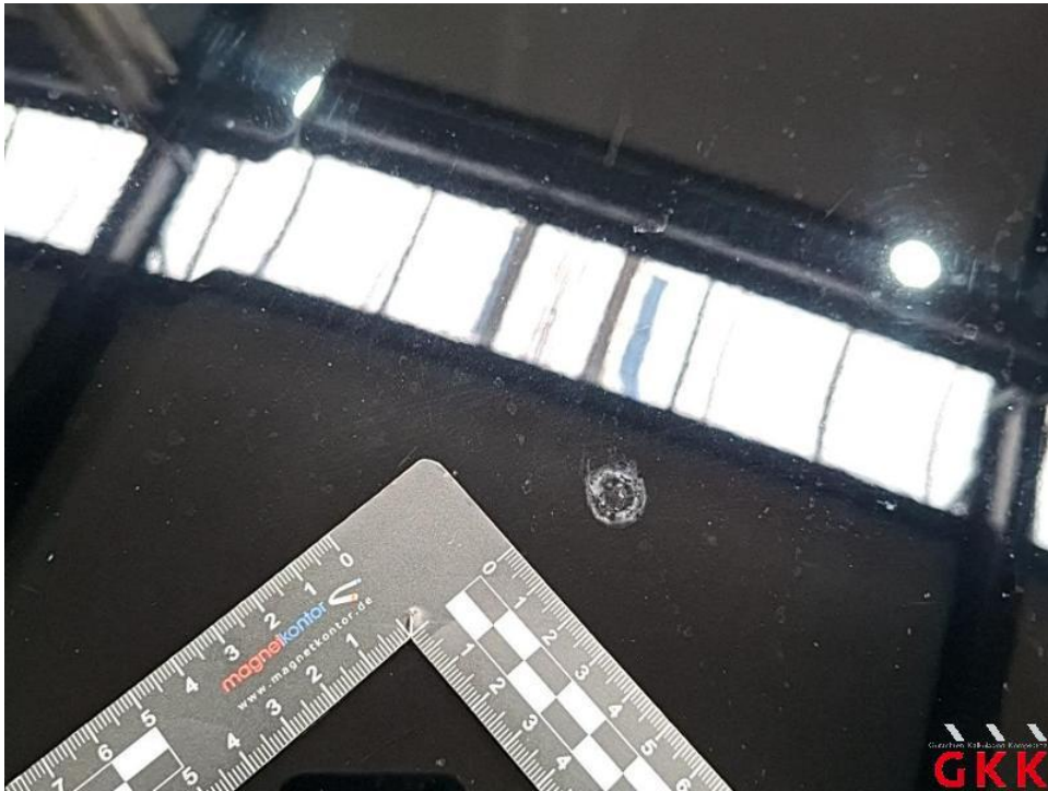
Bild 22. Motorhaube, Steinschlag und Kratzer, lackieren
