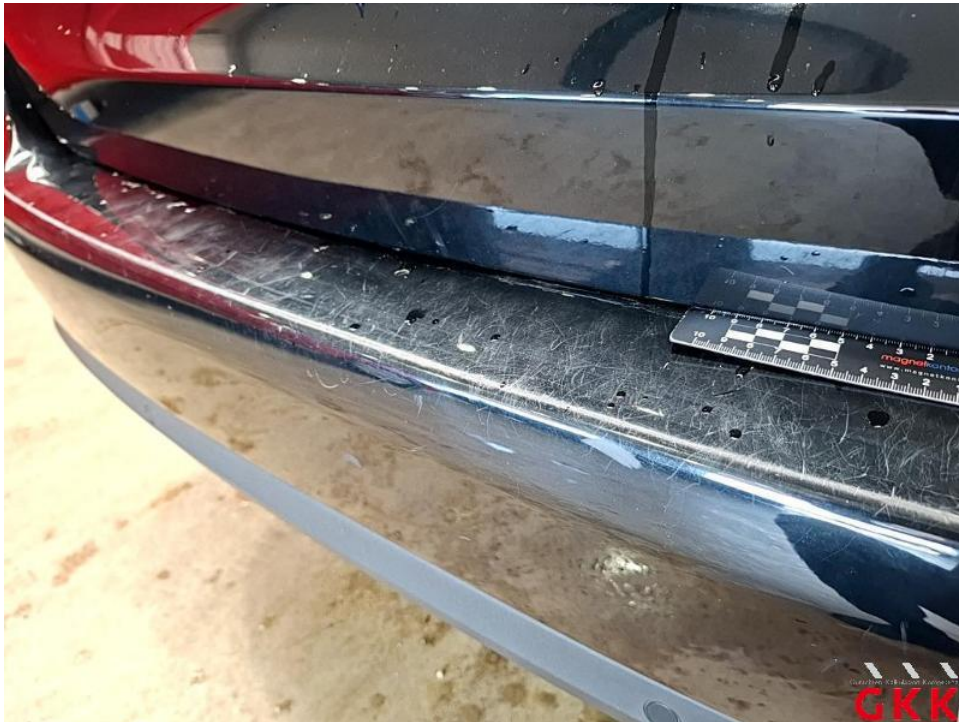
Bild 40. Stoßfänger hinten, Verkleidung -lackiert-, verkratzt, lackieren
