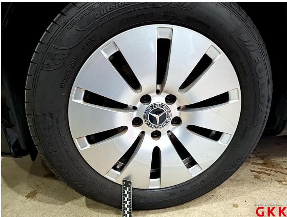
Bild 26. LM-Rad, vorne links, verkratzt, Smartrepair
