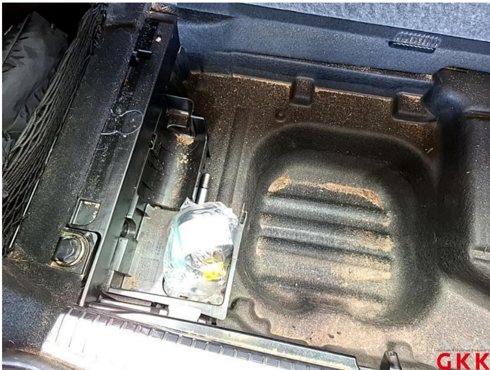
Bild 12. Reifenreparaturset, Füllkompressor, fehlt, ersetzen
