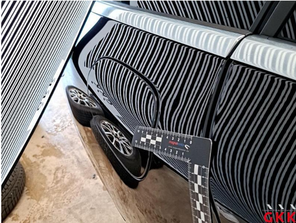
Bild 43. Seitenwand rechts, bis 3 Dellen / Bauteil, kalt drücken
