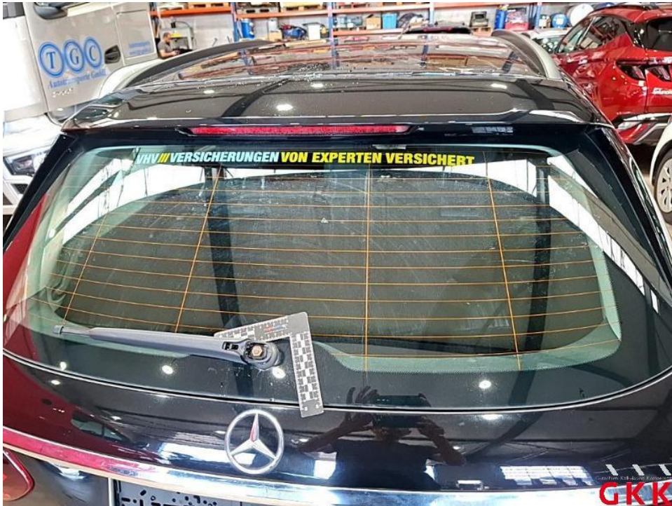
Bild 34. Heckscheibe, verkratzt, ersetzen
