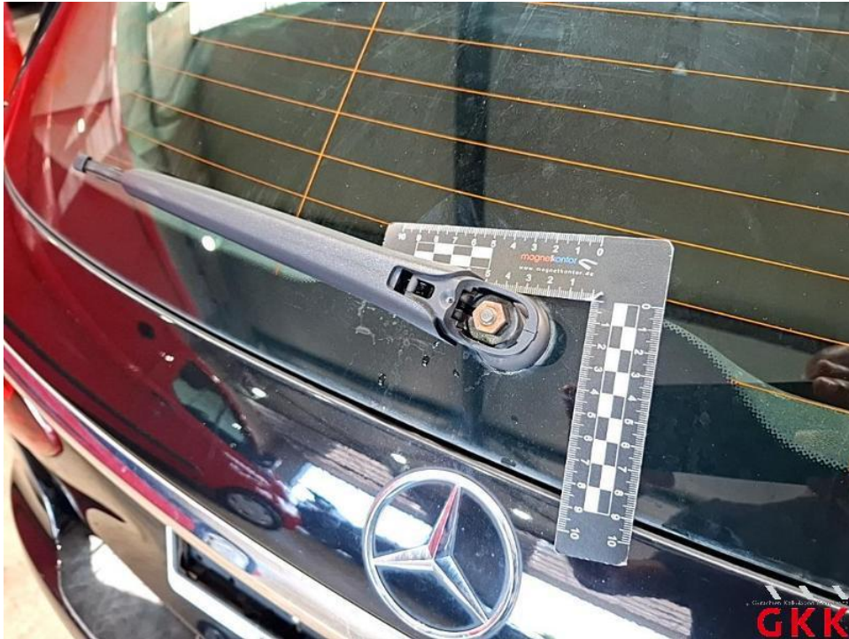
Bild 37. Heckwischer, Arm, beschädigt, ersetzen
