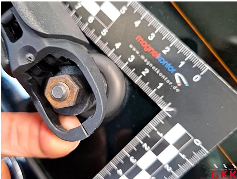
Bild 38. Heckwischer, Arm, beschädigt, ersetzen
