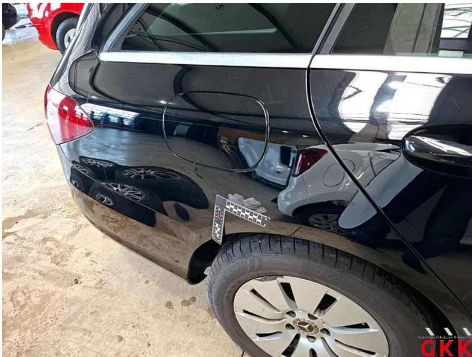
Bild 44. Seitenwand rechts, Reparaturmangel, aufbereiten
