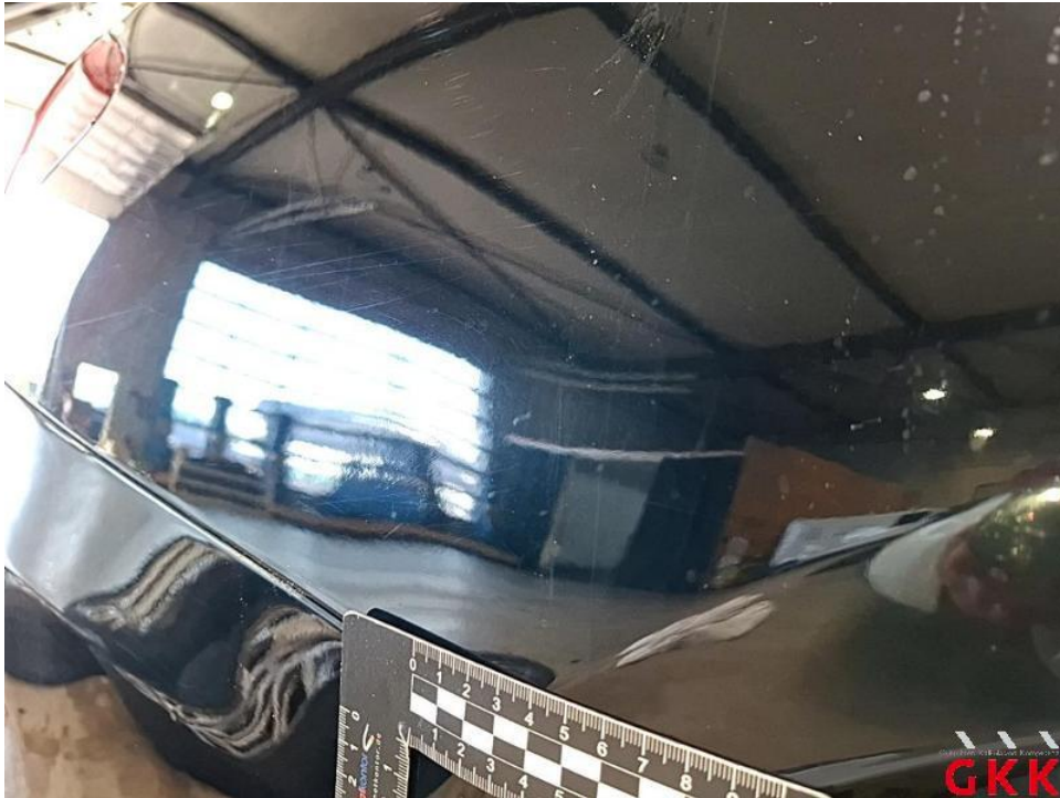
Bild 45. Seitenwand rechts, Reparaturmangel, aufbereiten
