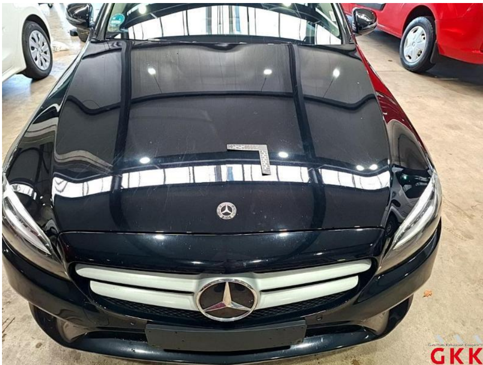
Bild 20. Motorhaube, Steinschlag und Kratzer, lackieren
