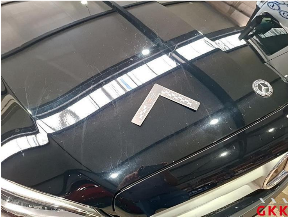
Bild 21. Motorhaube, Steinschlag und Kratzer, lackieren
