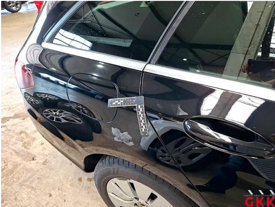
Bild 42. Seitenwand rechts, bis 3 Dellen / Bauteil, kalt drücken
