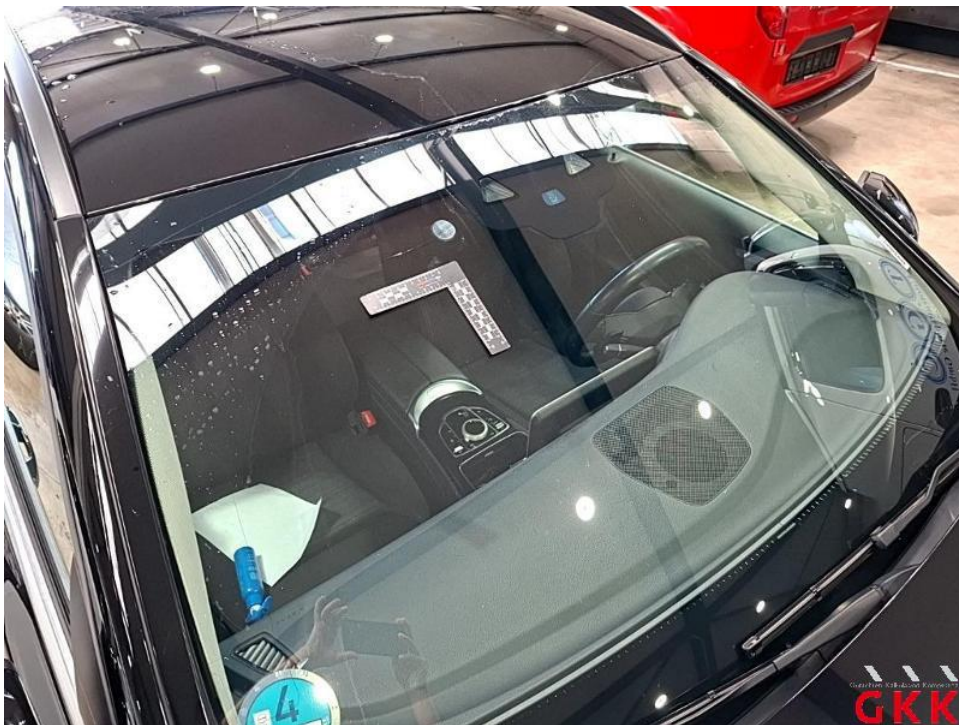
Bild 18. Frontscheibe, mit Regensensor und Frontkamera, gerissen, ersetzen
