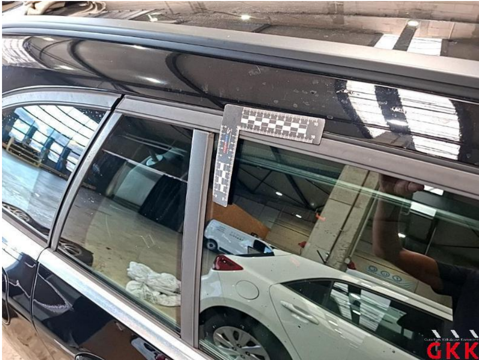
Bild 47. Dach, Holm rechts, verkratzt, auslegen, schleifen, polieren
