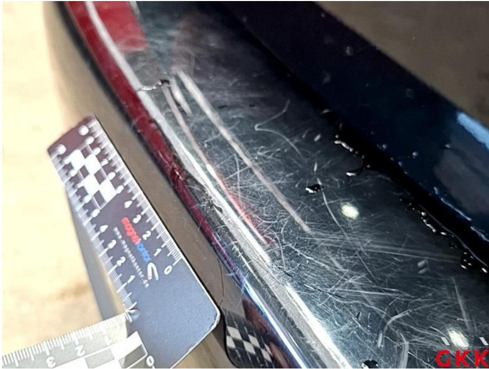
Bild 41. Stoßfänger hinten, Verkleidung -lackiert-, verkratzt, lackieren
