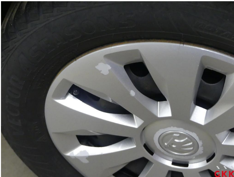
Bild 24 Radkappe(n), Satz, verkratzt, ersetzen
