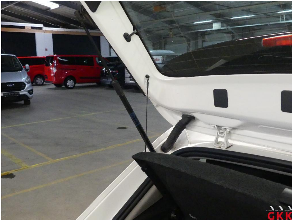
Bild 17 Laderaum, Abdeckung -Halteseil-, fehlt, ersetzen
