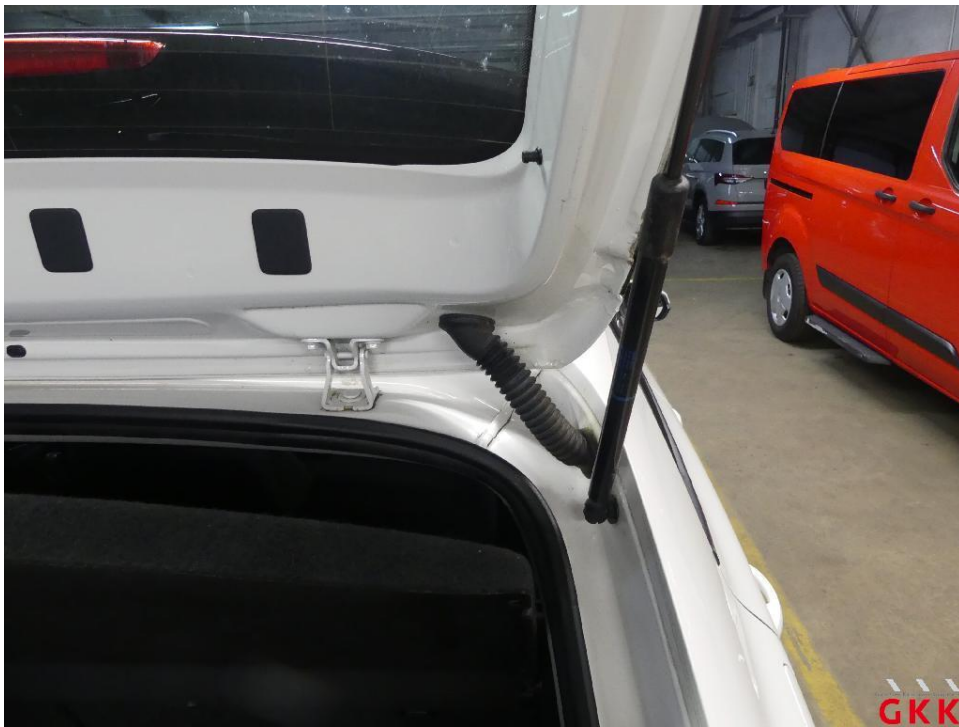
Bild 16 Laderaum, Abdeckung -Halteseil-, fehlt, ersetzen
