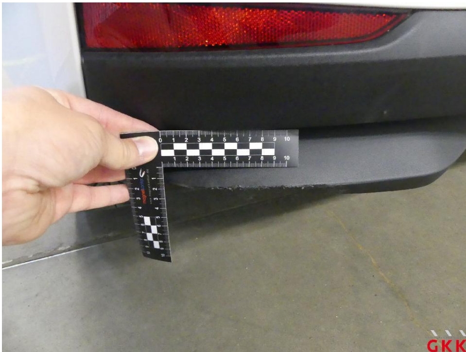
Bild 26 Stoßfänger hinten, Verkleidung unterhalb -unlackiert-, verkratzt, ersetzen
