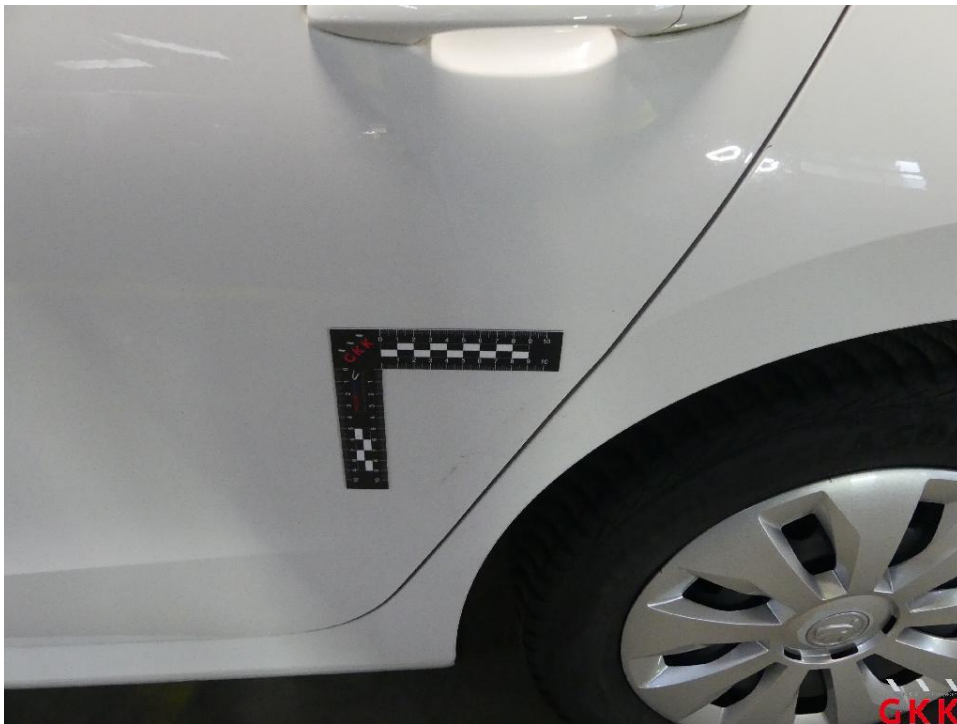
Bild 28 Tür hinten links, verkratzt, lackieren
