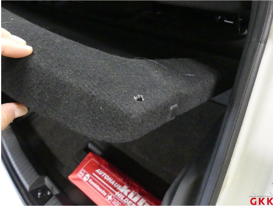
Bild 15 Laderaum, Abdeckung -Halteseil-, fehlt, ersetzen
