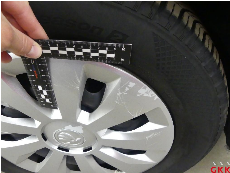
Bild 25 Radkappe(n), Satz, verkratzt, ersetzen
