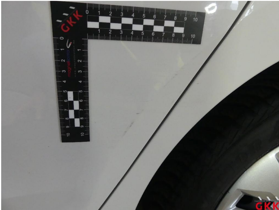
Bild 29 Tür hinten links, verkratzt, lackieren
