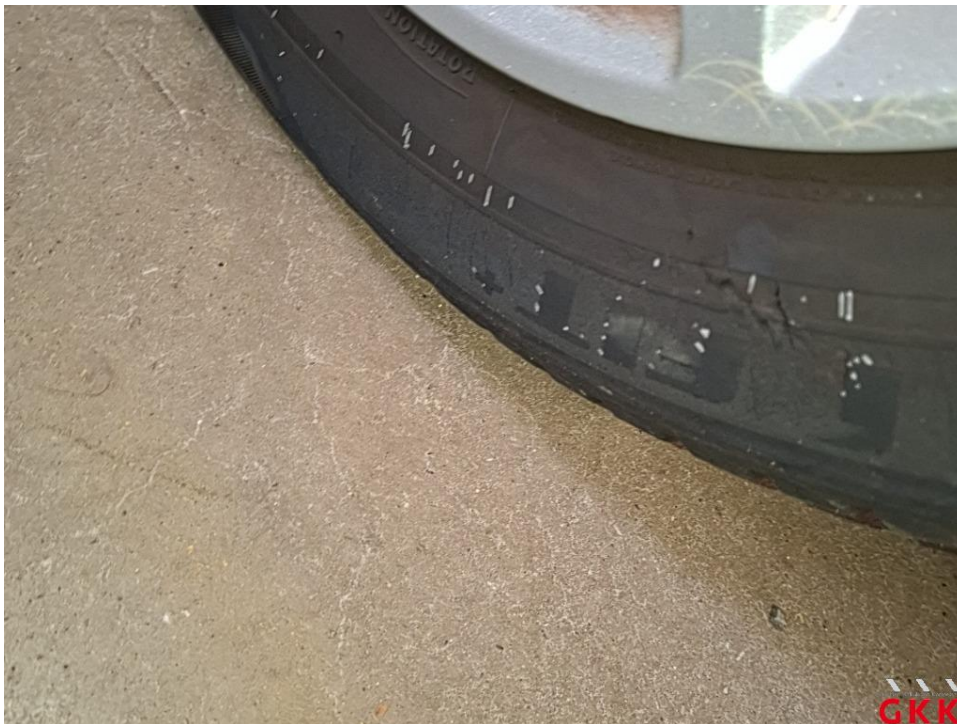
Bild 18 Satz Sommerreifen, fehlt, ersetzen
