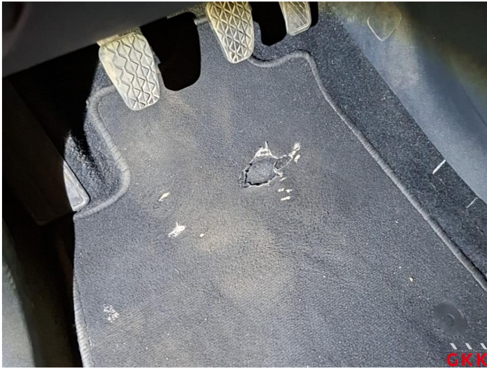
Bild 44 Fußmatte(n), vorne links, beschädigt, ersetzen
