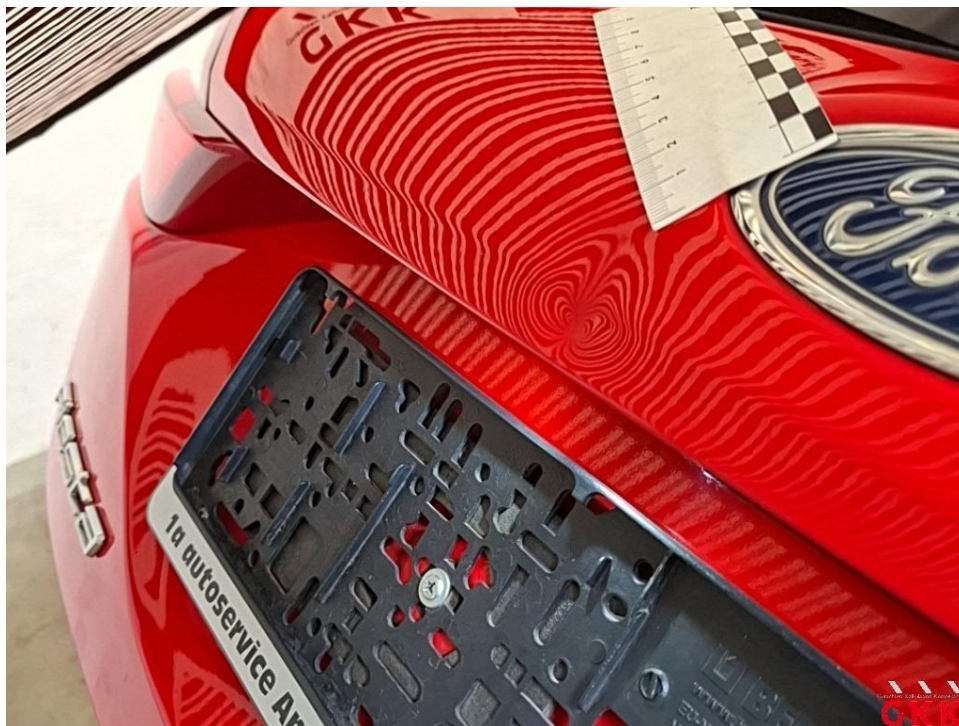
Bild 36 Heckklappe, beschädigt, ersetzen
