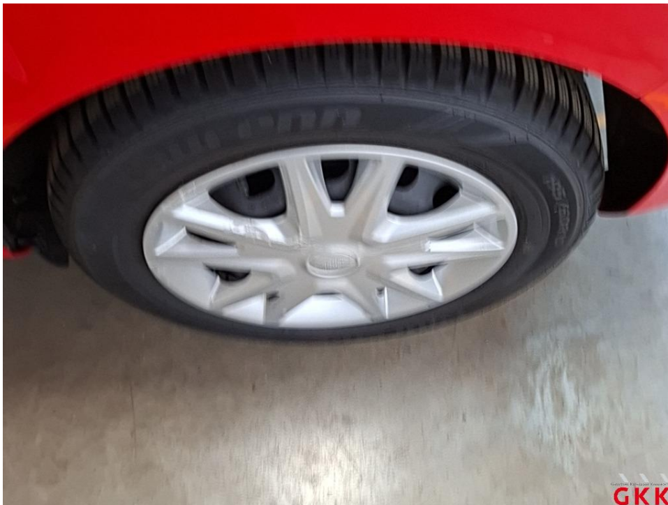
Bild 32 Radkappe(n), hinten links, beschädigt, ersetzen
