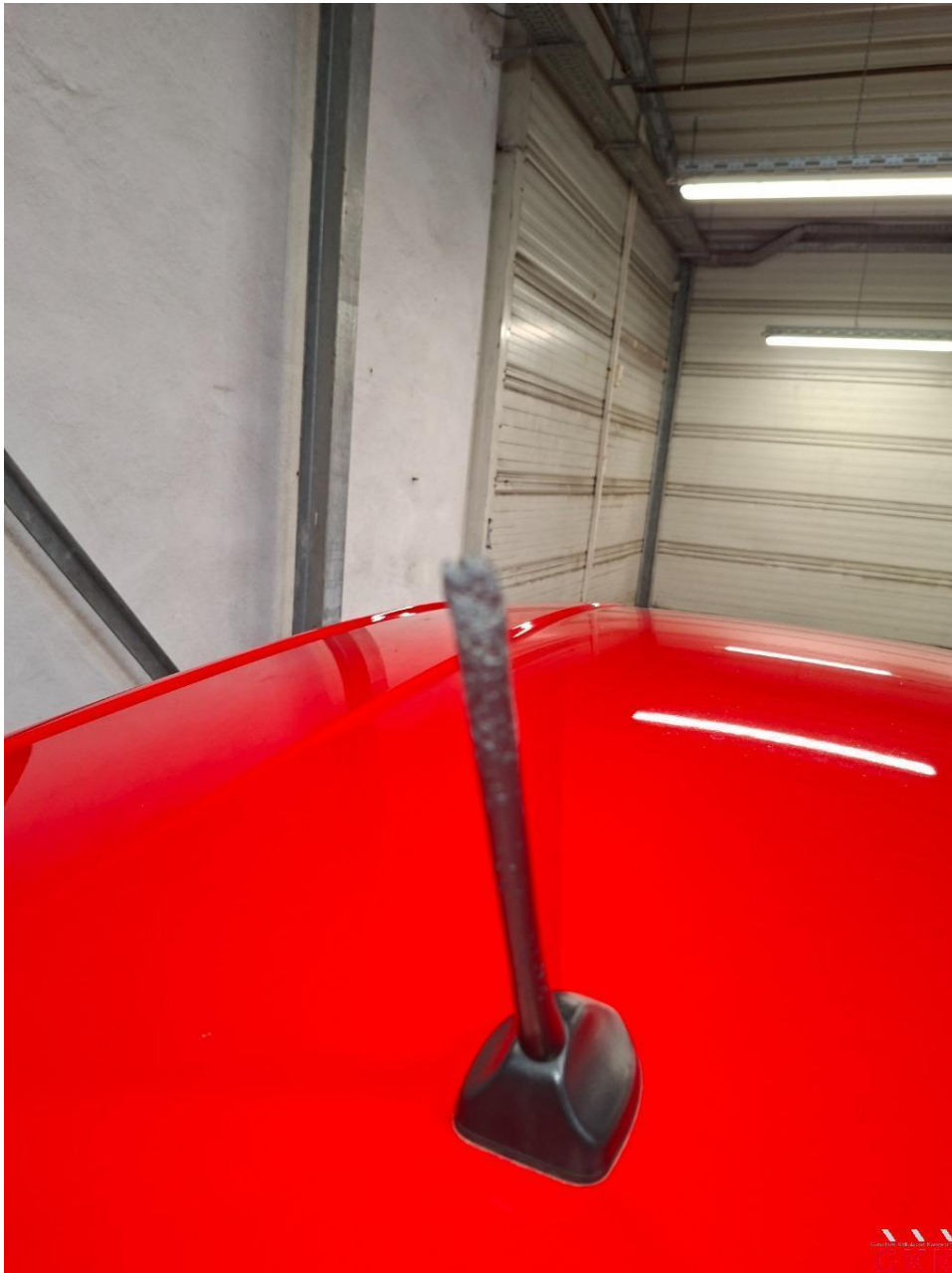
Bild 37 Antenne, Stab, beschädigt, ersetzen
