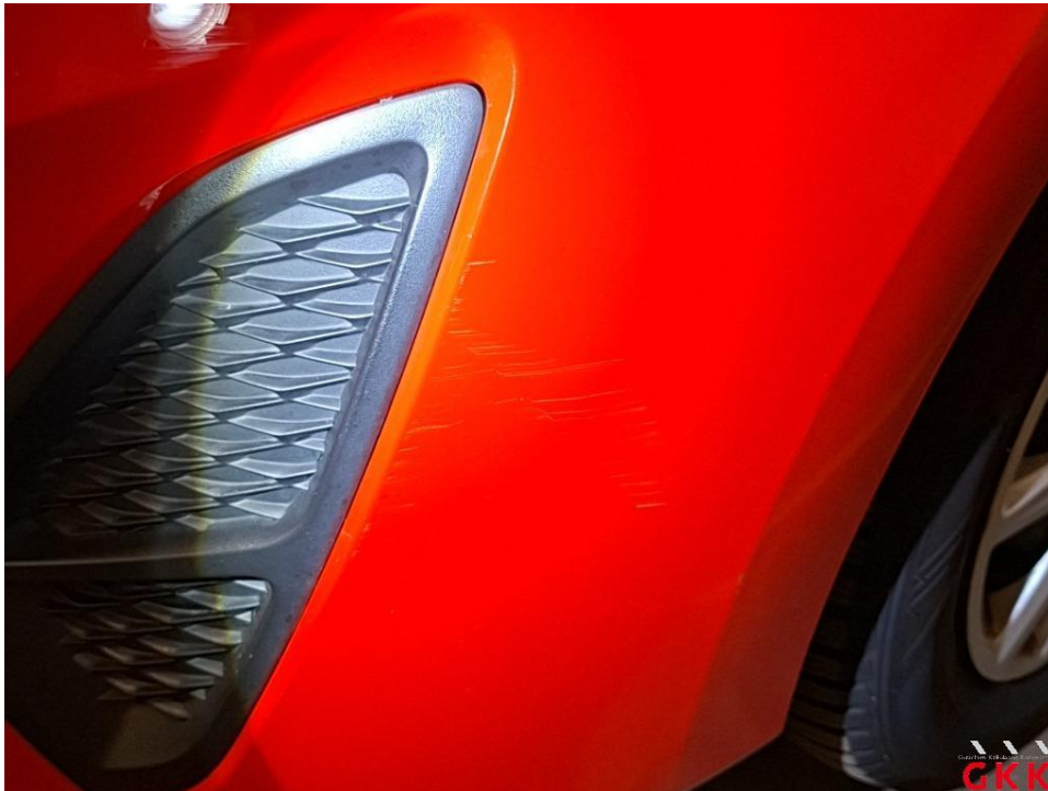
Bild 42 Stoßfänger vorne, Verkleidung -lackiert-, verkratzt, lackieren
