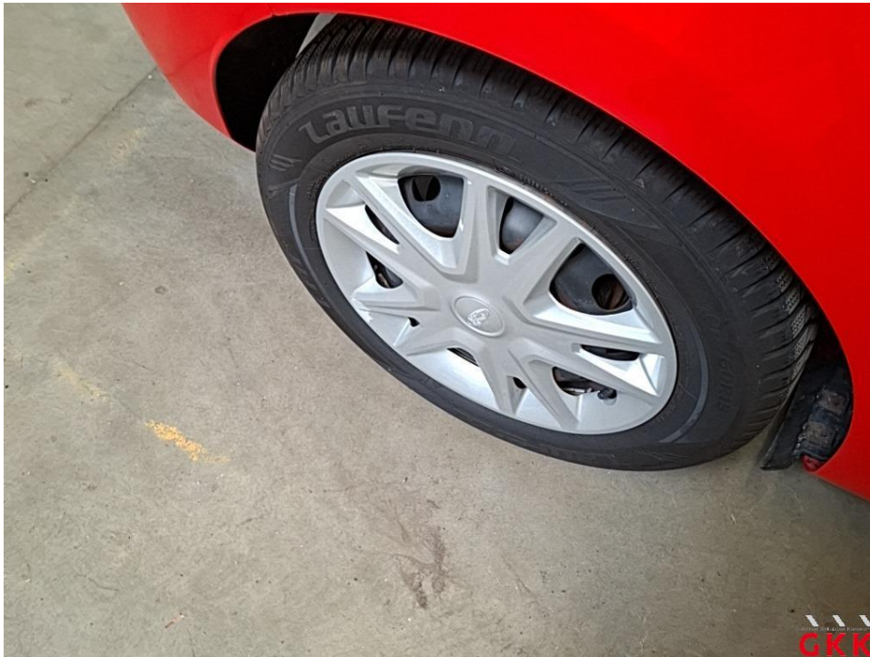
Bild 38 Radkappe(n), hinten rechts, beschädigt, ersetzen
