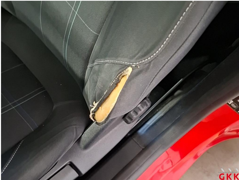
Bild 25 Sitz vorne links, Bezug Rückenlehne -Stoff-, beschädigt, ersetzen
