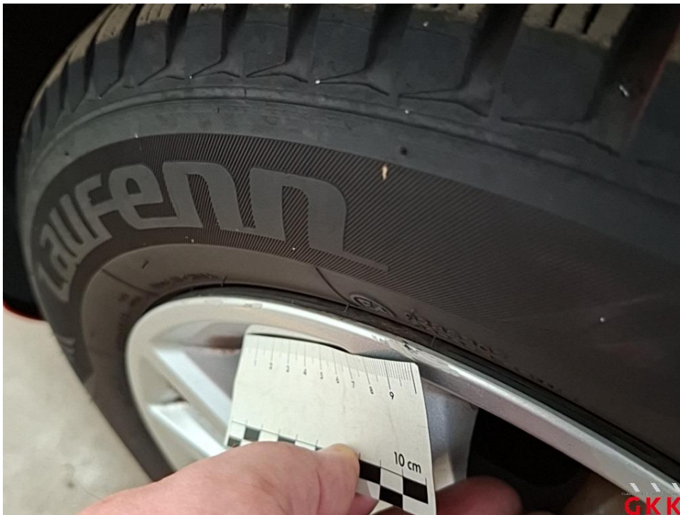
Bild 24 Radkappe(n), vorne links, beschädigt, ersetzen
