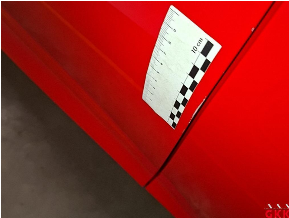
Bild 31 Tür vorne links, Kante, verkratzt, Smartrepair
