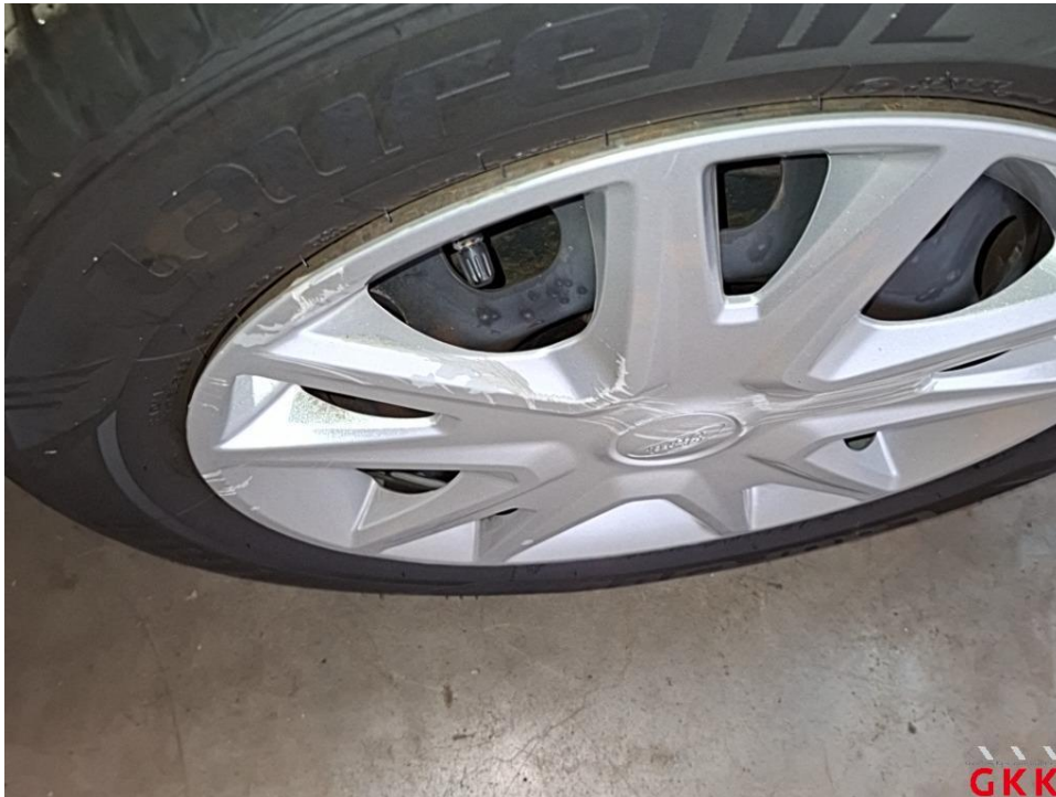
Bild 33 Radkappe(n), hinten links, beschädigt, ersetzen
