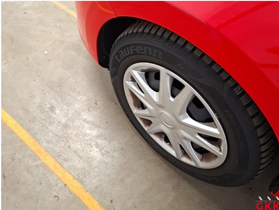
Bild 23 Radkappe(n), vorne links, beschädigt, ersetzen
