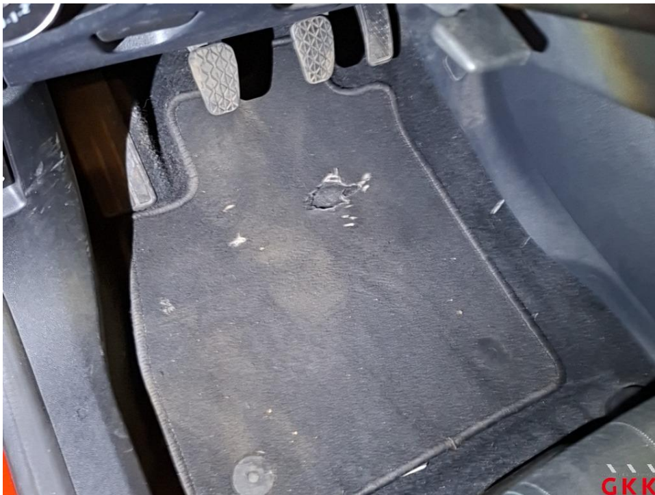
Bild 43 Fußmatte(n), vorne links, beschädigt, ersetzen
