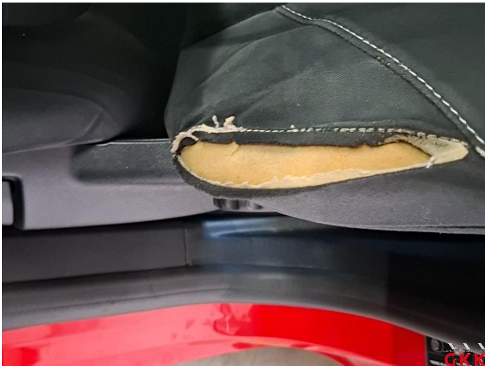
Bild 26 Sitz vorne links, Bezug Rückenlehne -Stoff-, beschädigt, ersetzen
