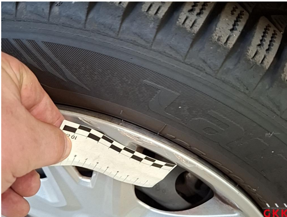
Bild 20 Radkappe(n), vorne rechts, beschädigt, ersetzen
