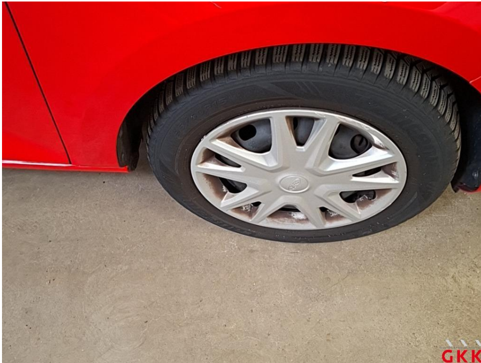
Bild 19 Radkappe(n), vorne rechts, beschädigt, ersetzen
