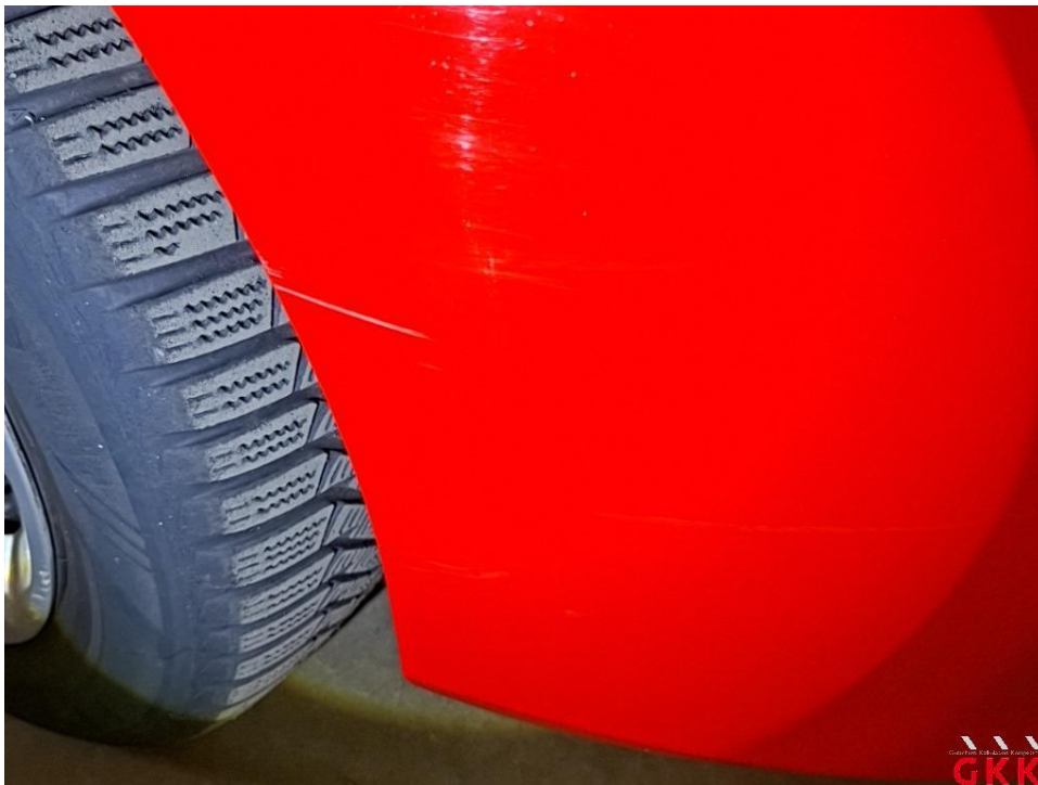
Bild 41 Stoßfänger vorne, Verkleidung -lackiert-, verkratzt, lackieren
