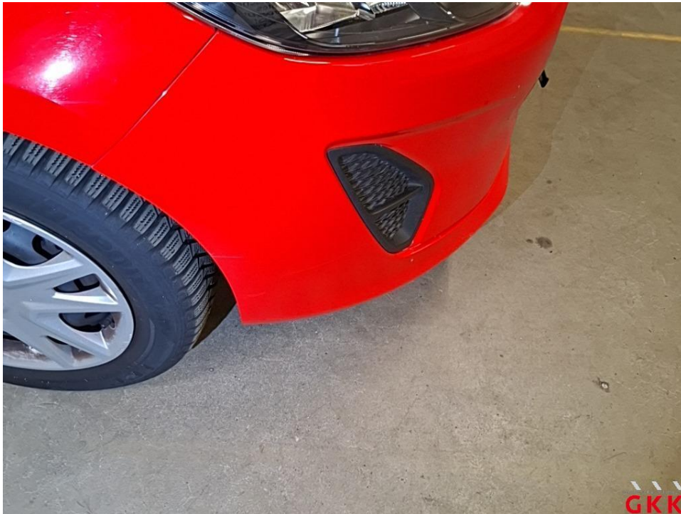
Bild 40 Stoßfänger vorne, Verkleidung -lackiert-, verkratzt, lackieren
