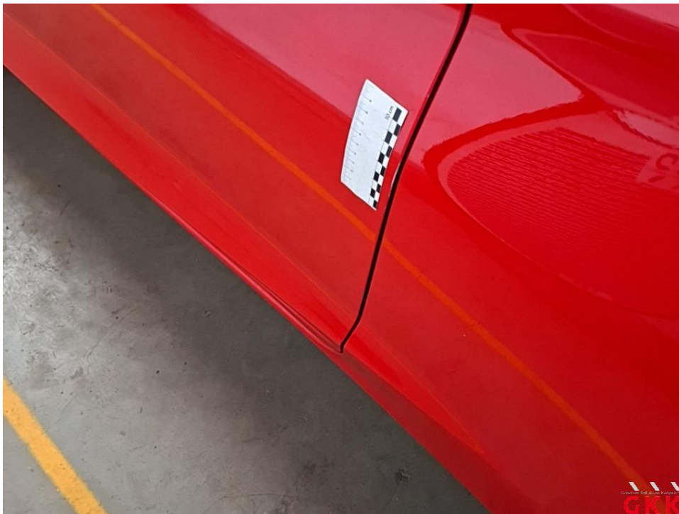
Bild 30 Tür vorne links, Kante, verkratzt, Smartrepair
