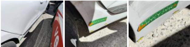
Door trim FR, Scratch(es), Replace
