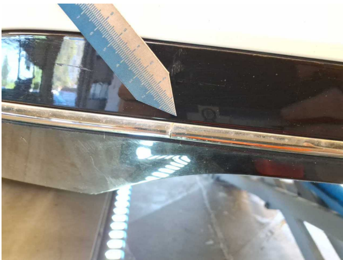
Damage 11: Rear bumper: Spoiler (Zierleiste) - Broken / torn - Replace
