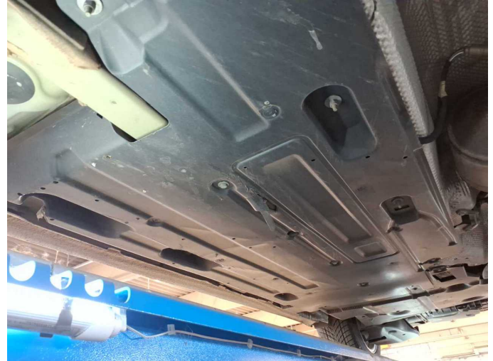
Damage 15: Body: Underbody panelling (Rechts und links) - Broken / torn - Replace
