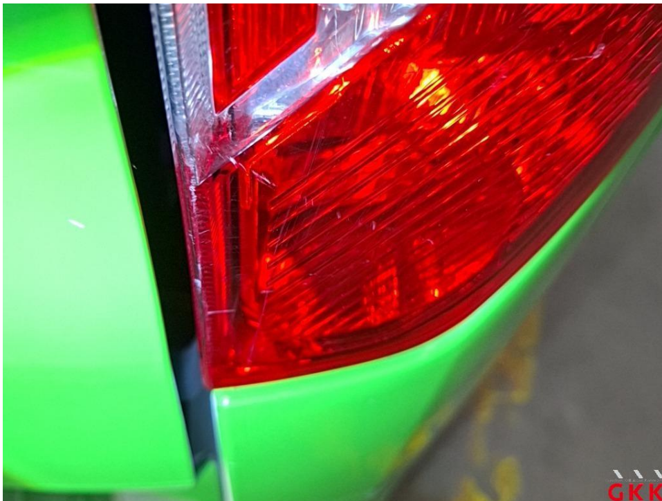
Bild 54 Rückleuchte rechts, außen, verkratzt, ersetzen
