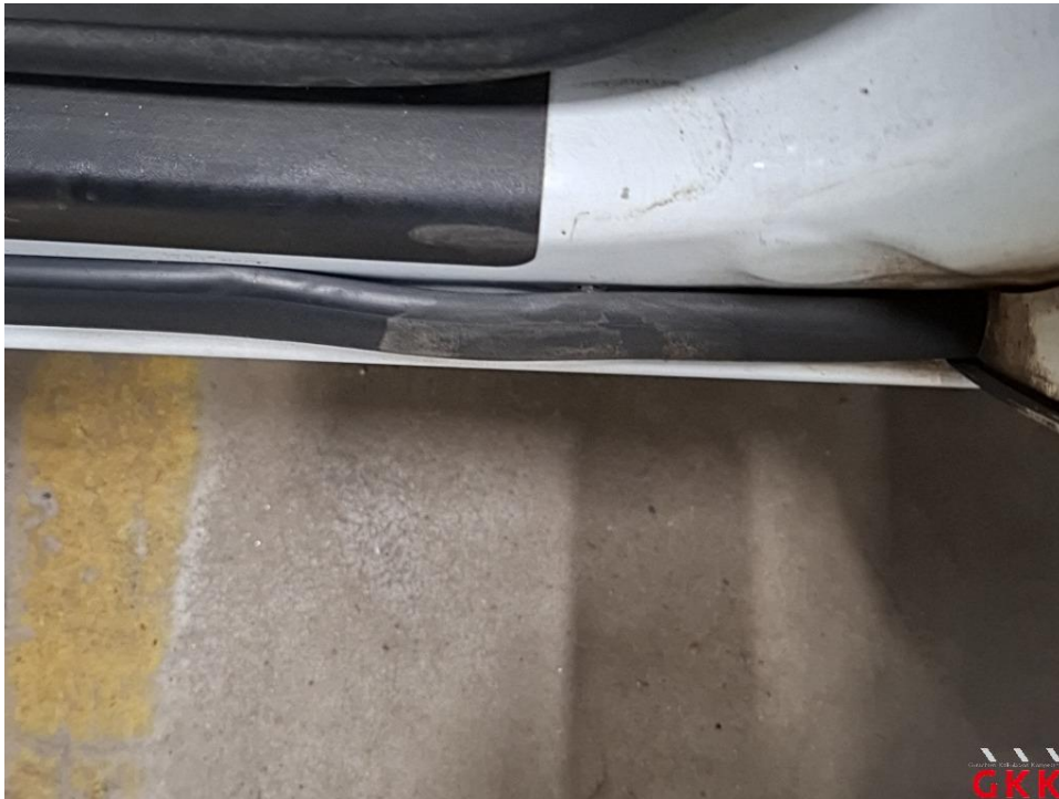
Bild 41 Tür vorne links, Dichtung -Einstieg-, beschädigt, ersetzen
