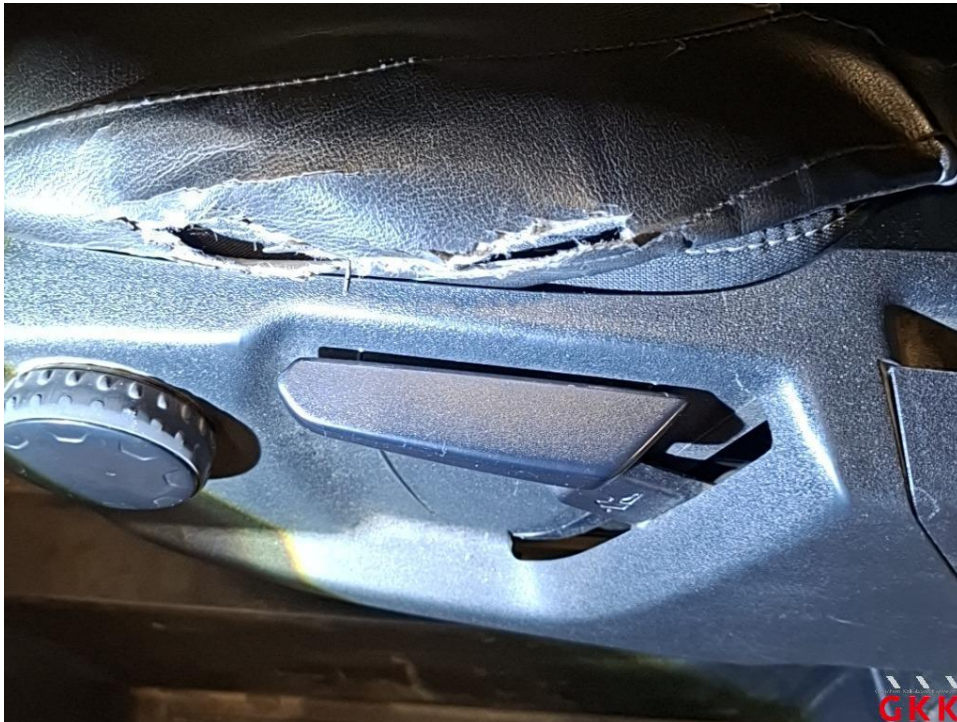
Bild 25 Sitz vorne links, Schonbezug, beschädigt, ersetzen
