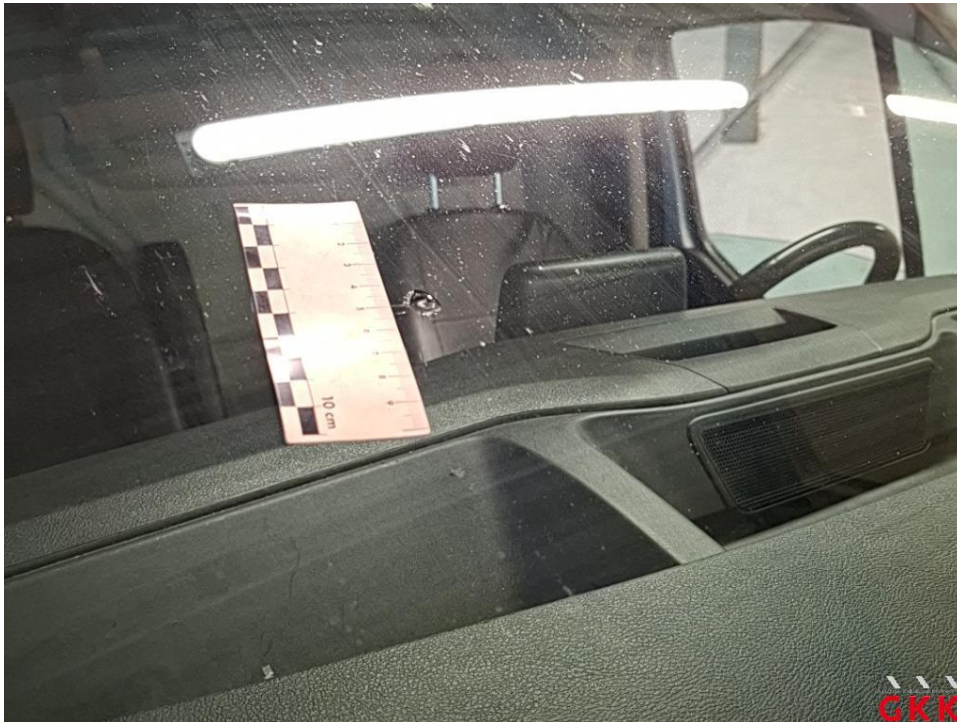
Bild 33 Frontscheibe, beheizt mit Regensensor, Steinschlag mit Rissbildung, ersetzen
