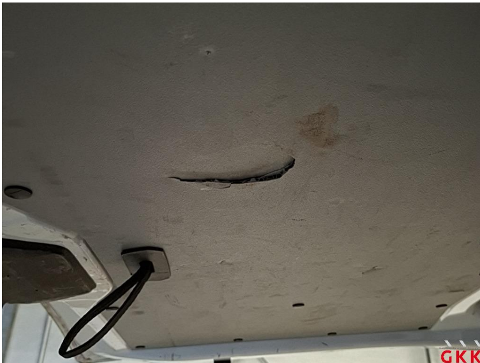
Bild 16 Heckklappe, Innenverkleidung, beschädigt, ersetzen
