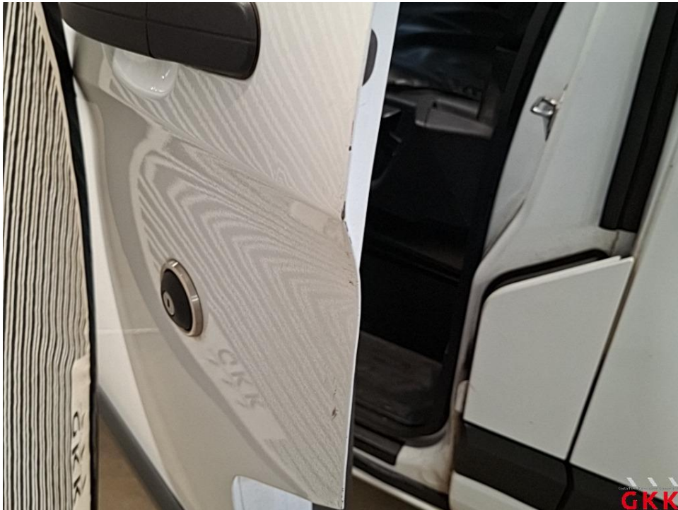
Bild 39 Tür vorne links, verkratzt, lackieren
