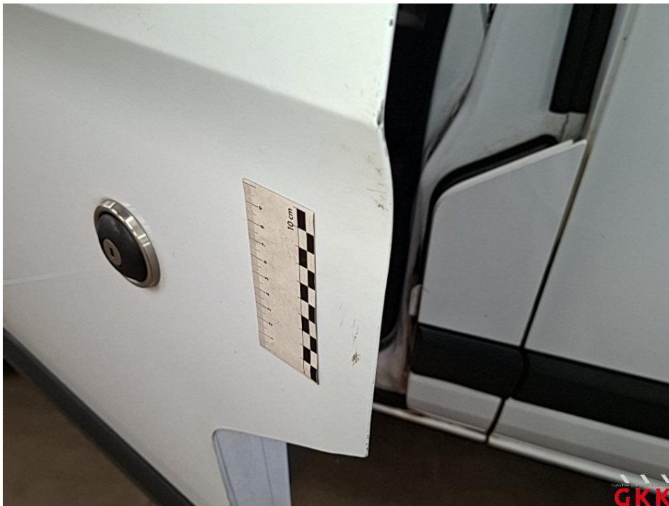
Bild 38 Tür vorne links, verkratzt, lackieren
