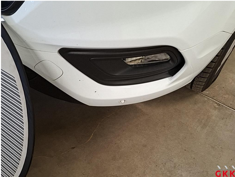
Bild 35 Stoßfänger vorne, Verkleidung unterhalb -lackiert-, beschädigt, lackieren
