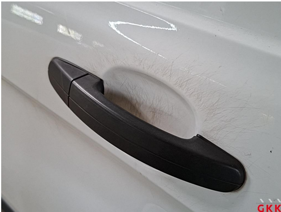
Bild 50 Fahrzeug, außen, Lackierung verwittert / matt, aufbereiten
