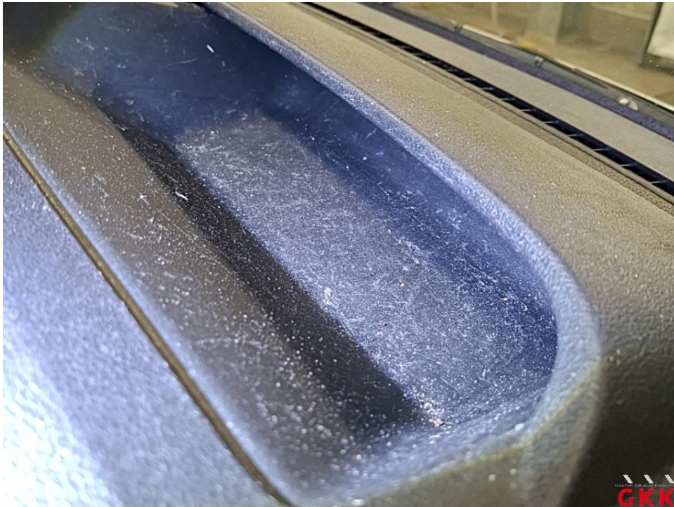
Bild 23 Fahrzeug, innen, verkratzt und verschmutzt, aufbereiten
