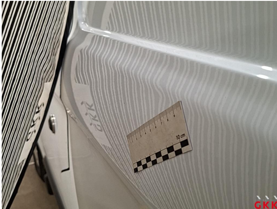
Bild 43 Seitenwand links, beschädigt, instand setzen - lackieren
