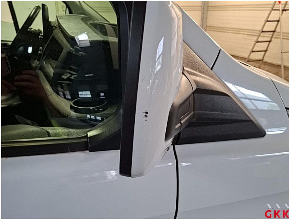
Bild 29 Spiegelgehäuse rechts, Kappe -lackiert-, verkratzt, lackieren
