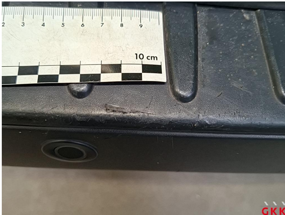
Bild 46 Stoßfänger hinten, Verkleidung -unlackiert-, beschädigt, ersetzen
