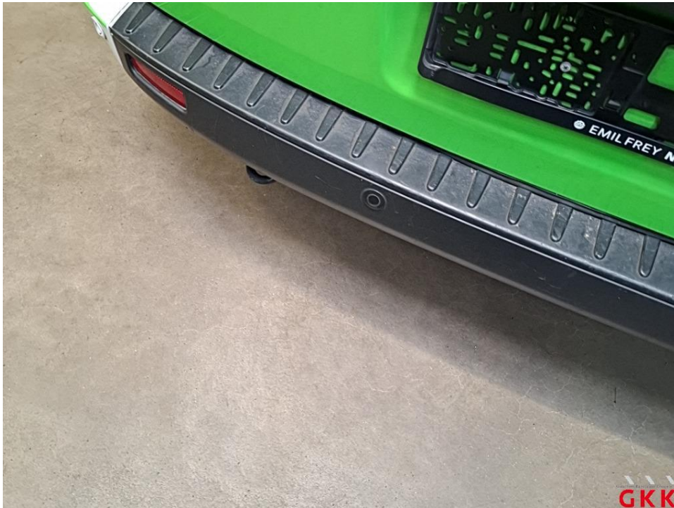
Bild 45 Stoßfänger hinten, Verkleidung -unlackiert-, beschädigt, ersetzen
