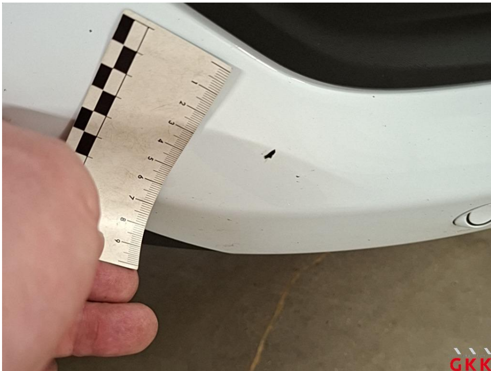
Bild 36 Stoßfänger vorne, Verkleidung unterhalb -lackiert-, beschädigt, lackieren
