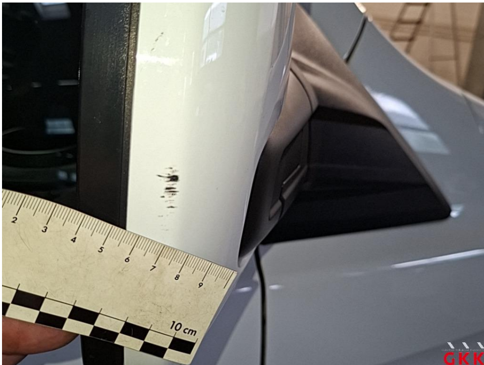
Bild 30 Spiegelgehäuse rechts, Kappe -lackiert-, verkratzt, lackieren
