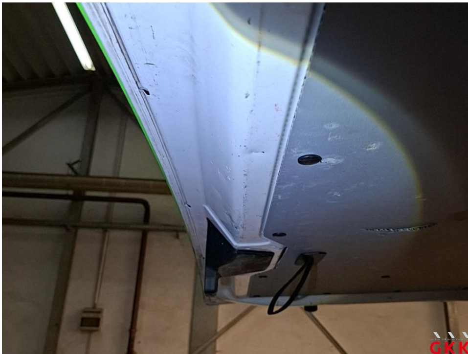
Bild 18 Heckklappe, innen, beschädigt, Smartrepair
