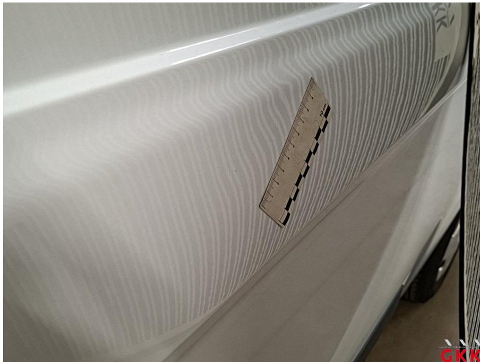
Bild 44 Seitenwand links, beschädigt, instand setzen - lackieren
