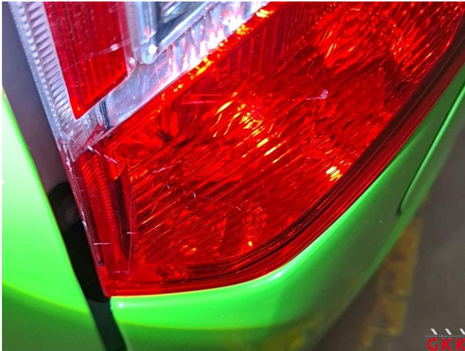
Bild 53 Rückleuchte rechts, außen, verkratzt, ersetzen
