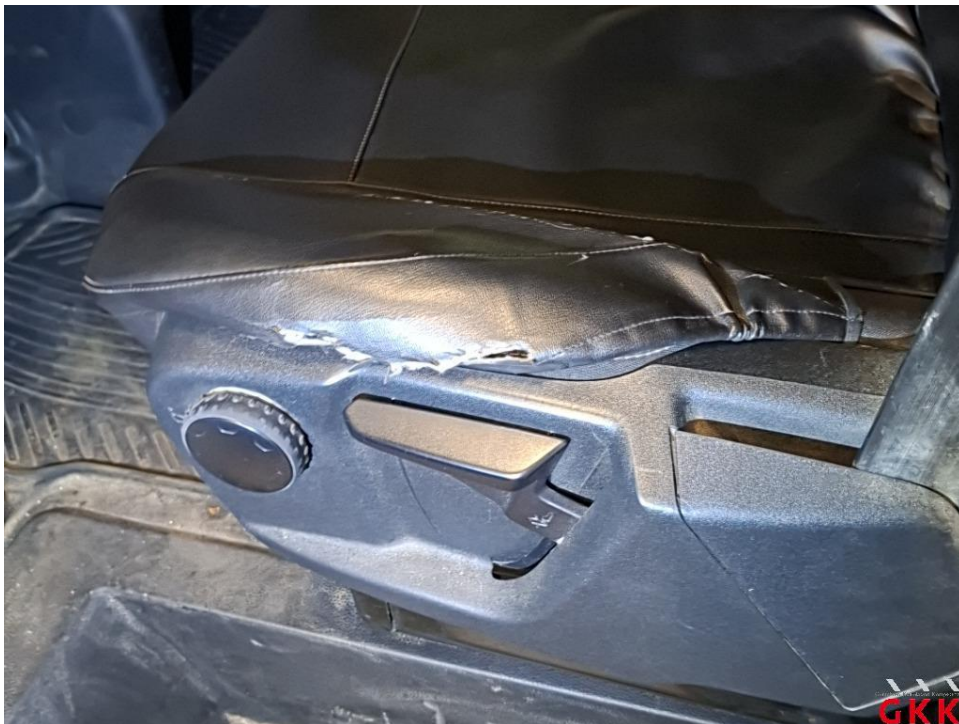
Bild 24 Sitz vorne links, Schonbezug, beschädigt, ersetzen
