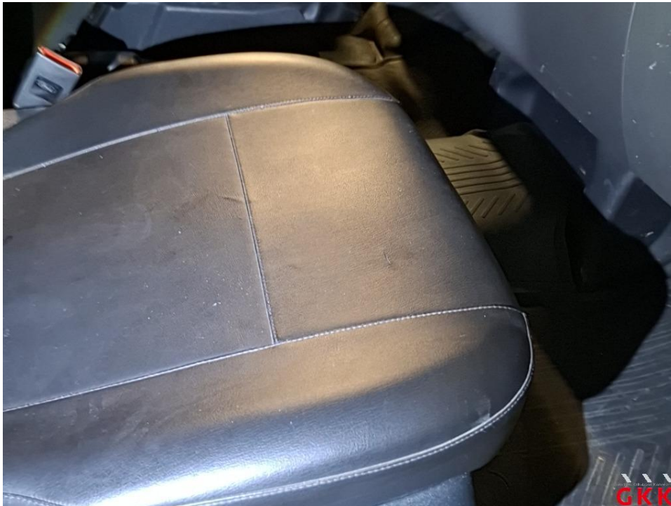
Bild 19 Sitz vorne rechts, Schonbezug, beschädigt, ersetzen
