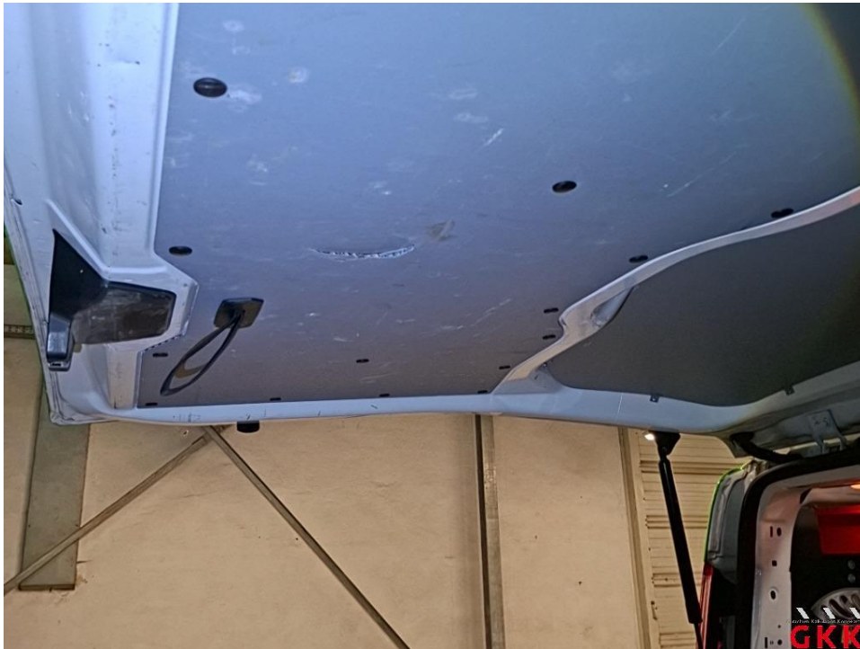
Bild 15 Heckklappe, Innenverkleidung, beschädigt, ersetzen
