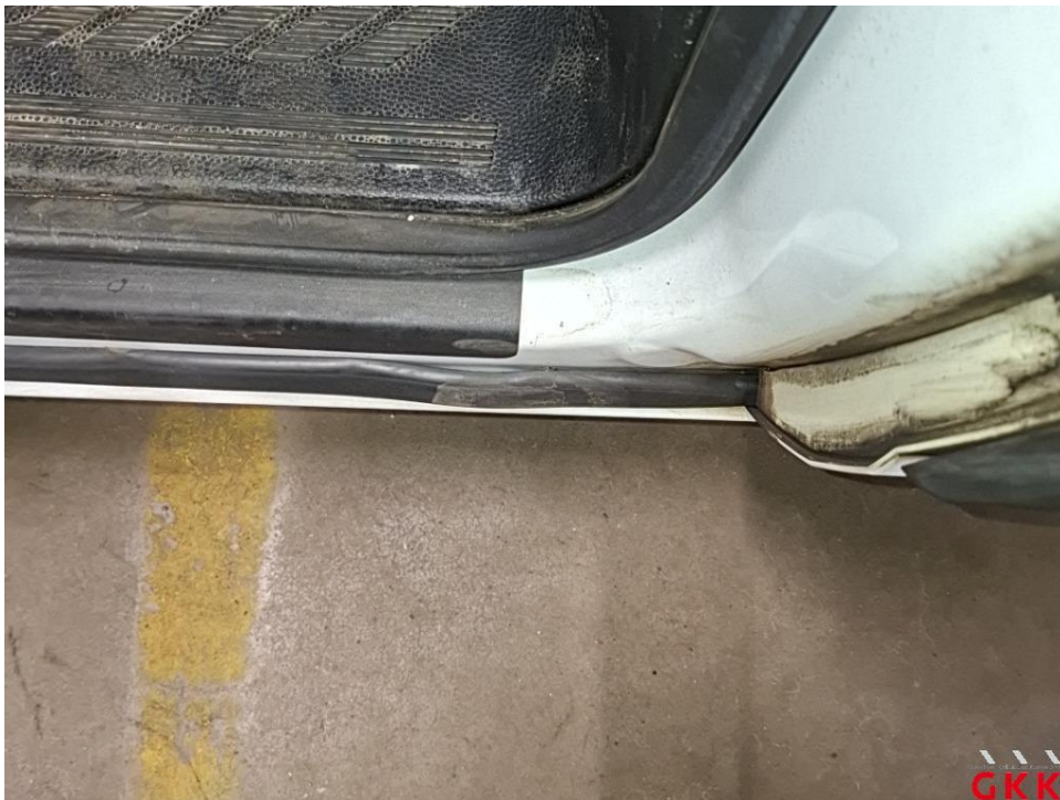
Bild 40 Tür vorne links, Dichtung -Einstieg-, beschädigt, ersetzen
