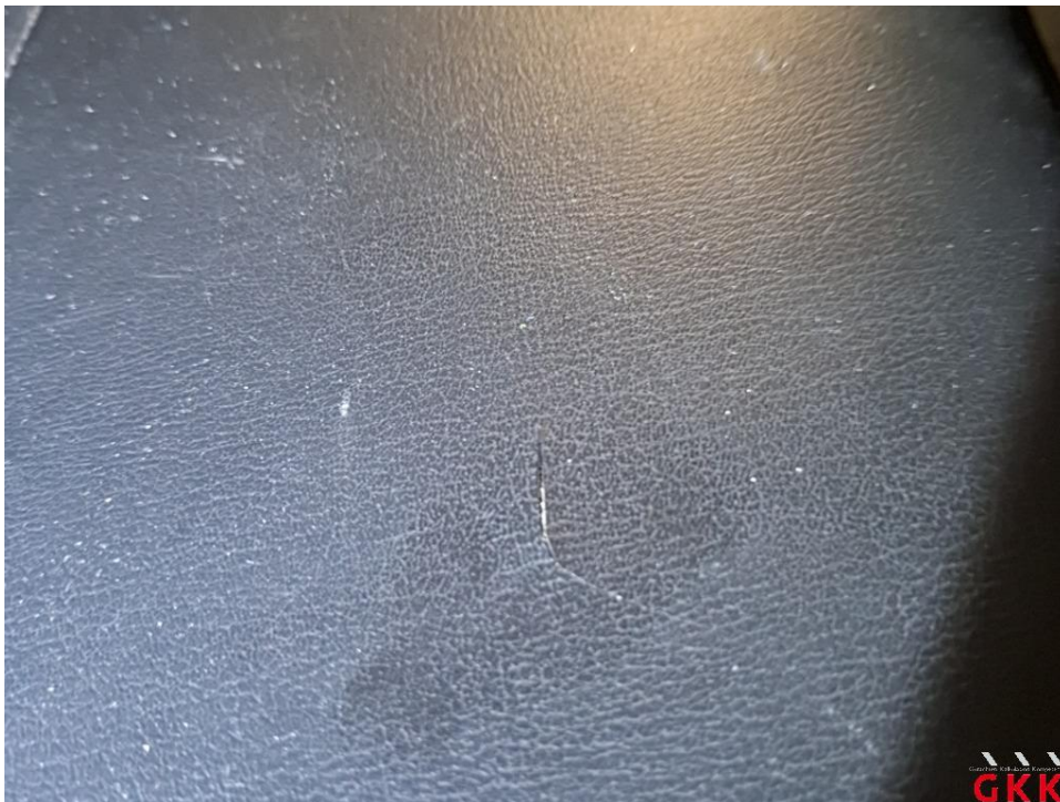
Bild 20 Sitz vorne rechts, Schonbezug, beschädigt, ersetzen
