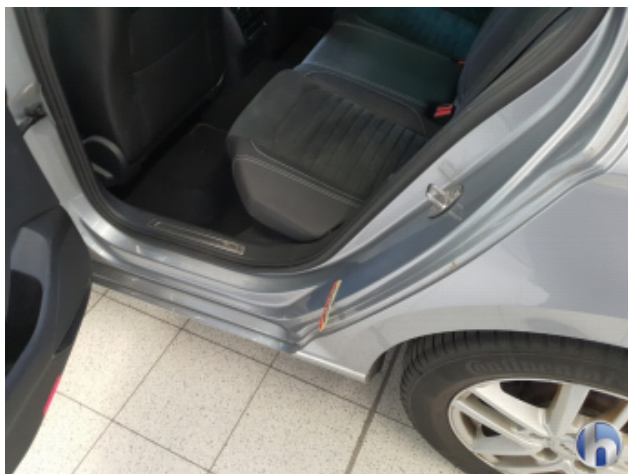
6. Türeinstieg Hinten - Links 1 Delle - Sanft Instandsetzen
