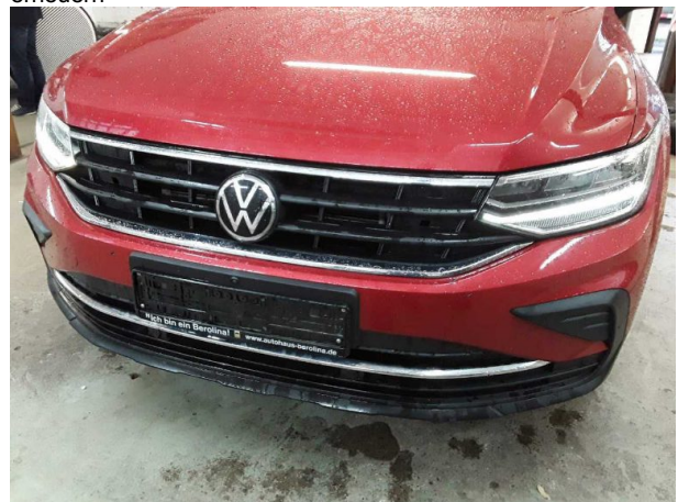
Beschädigung #6: Stossfänger vorn: Spoiler - verformt - erneuern
