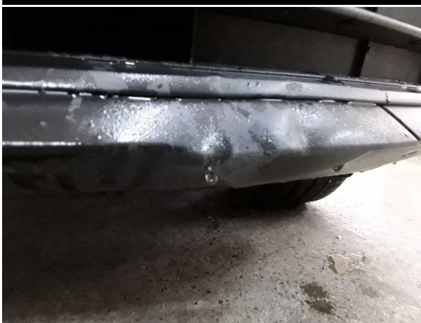
Beschädigung #6: Stossfänger vorn: Spoiler - verformt - erneuern
