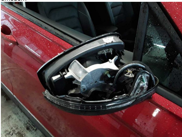
Beschädigung #5: Außenspiegel rechts: Abdeckkappe - lose - erneuern
