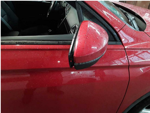
Beschädigung #5: Außenspiegel rechts: Abdeckkappe - lose - erneuern
