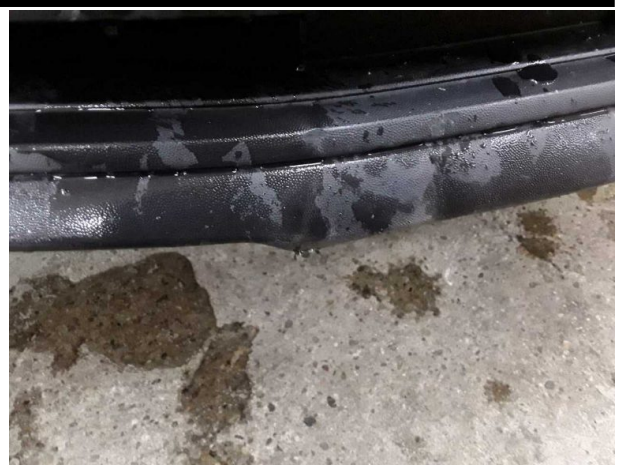
Beschädigung #6: Stossfänger vorn: Spoiler - verformt - erneuern
