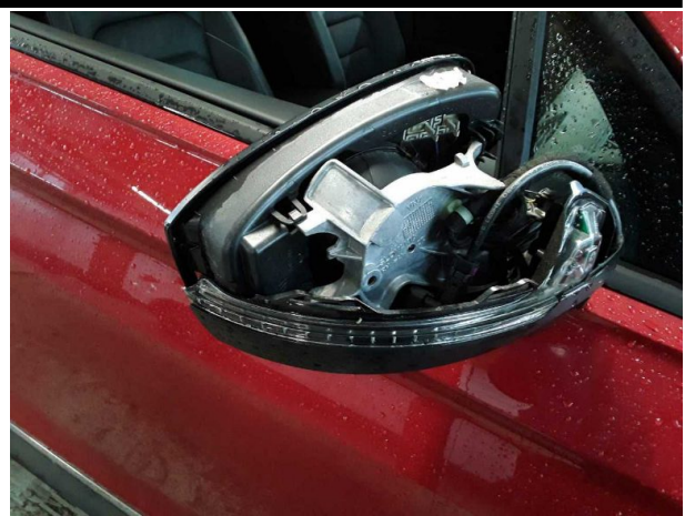
Beschädigung #4: Außenspiegel rechts: Spiegelgehäuse - lose - befunden ggf. instandsetzen
