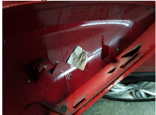
Beschädigung #5: Außenspiegel rechts: Abdeckkappe - lose - erneuern
