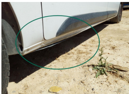
Bas de caisse / Arrière Droit / Enfoncement
