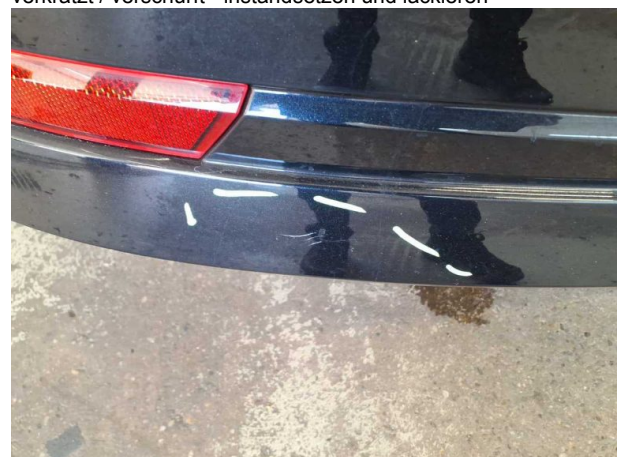
Beschädigung #7: Stossfänger hinten: Stossfänger hinten - verkratzt / verschürft - instandsetzen und lackieren
