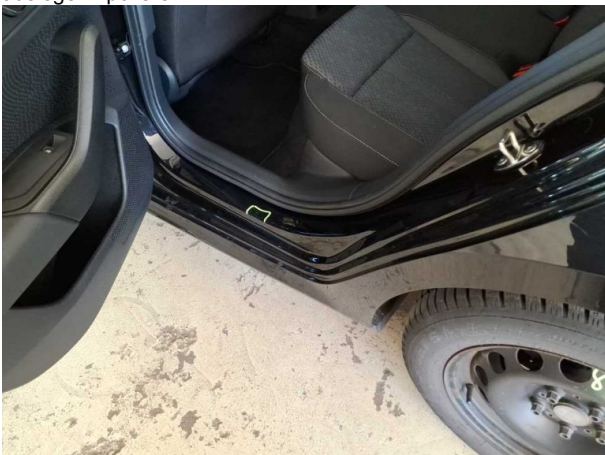
Beschädigung #5: Seitenwand links: Einstieg - Delle(n) - sanft instandsetzen
