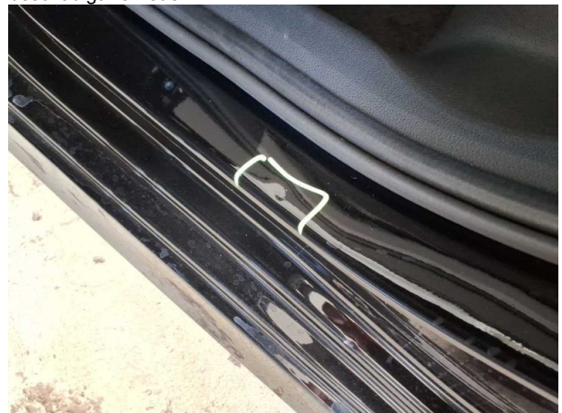
Beschädigung #5: Seitenwand links: Einstieg - Delle(n) - sanft instandsetzen
