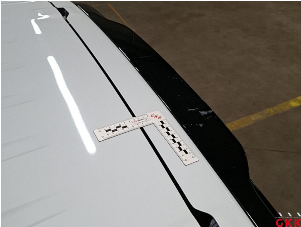
Bild 25 Heckklappe, Spoiler -lackiert-, verkratzt, lackieren
