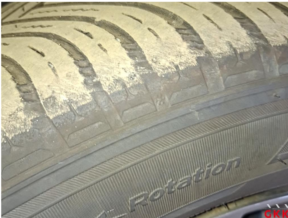
Bild 14 Reifen, vorn links und rechts, einseitig abgefahren, ersetzen
