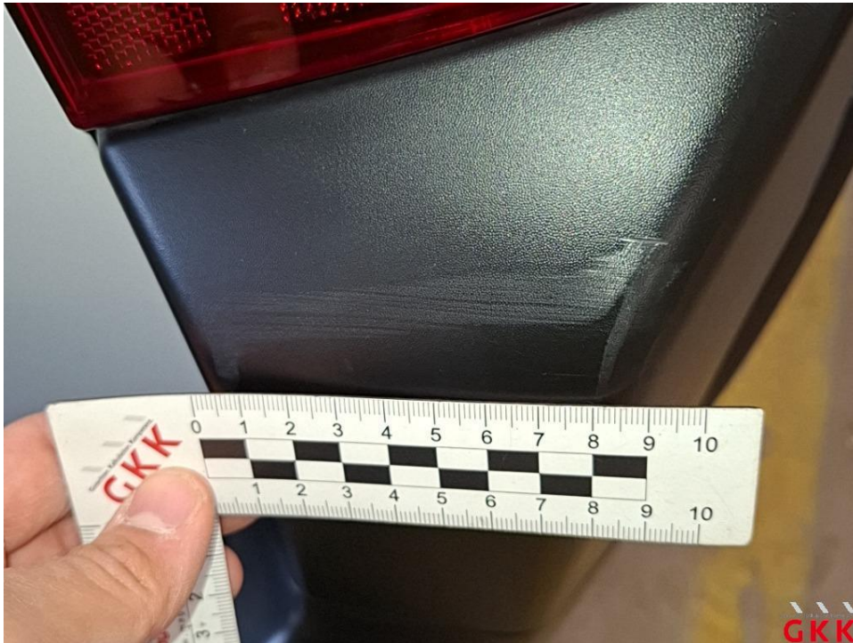
Bild 19 Stoßfänger hinten, Ecke rechts -unlackiert-, verkratzt, ersetzen
