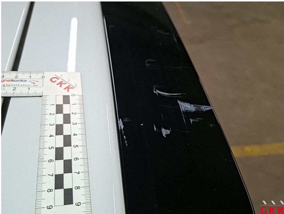
Bild 26 Heckklappe, Spoiler -lackiert-, verkratzt, lackieren
