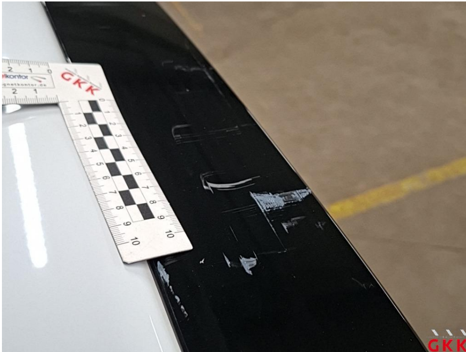
Bild 27 Heckklappe, Spoiler -lackiert-, verkratzt, lackieren
