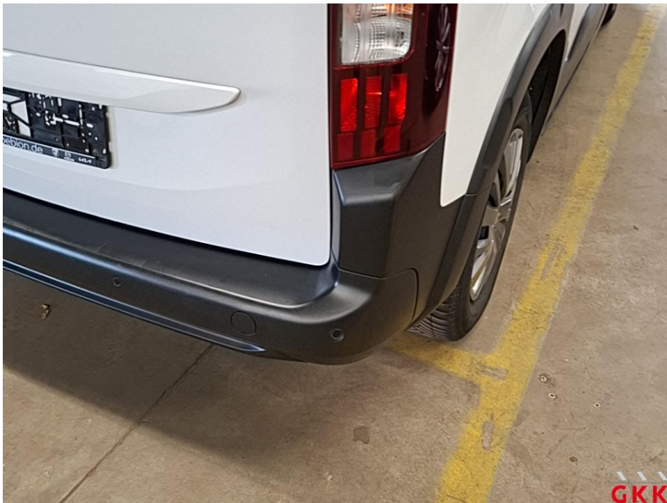
Bild 18 Stoßfänger hinten, Ecke rechts -unlackiert-, verkratzt, ersetzen
