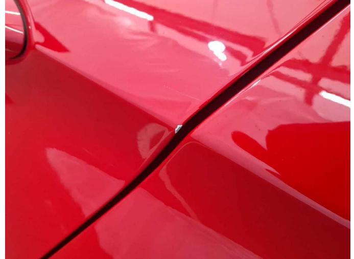
Damage 3: Door - rear left side: Door edge - Scratch(es) - Smart repair
