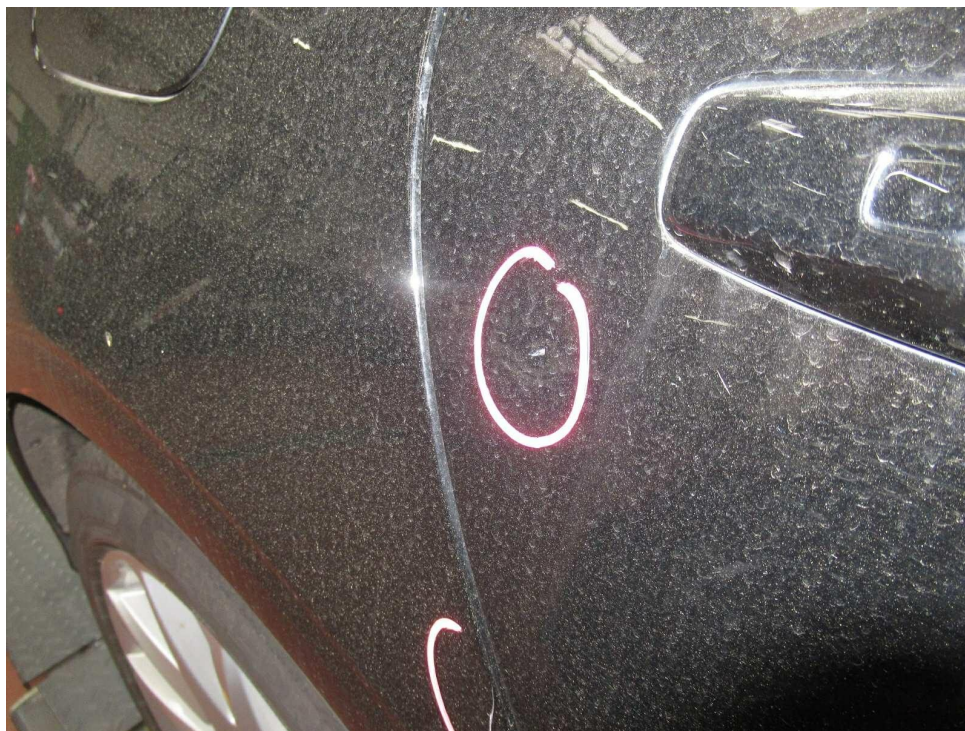
Bild 8 : Tür hinten rechts eingedellt Seitenwand rechts zerkratzt
