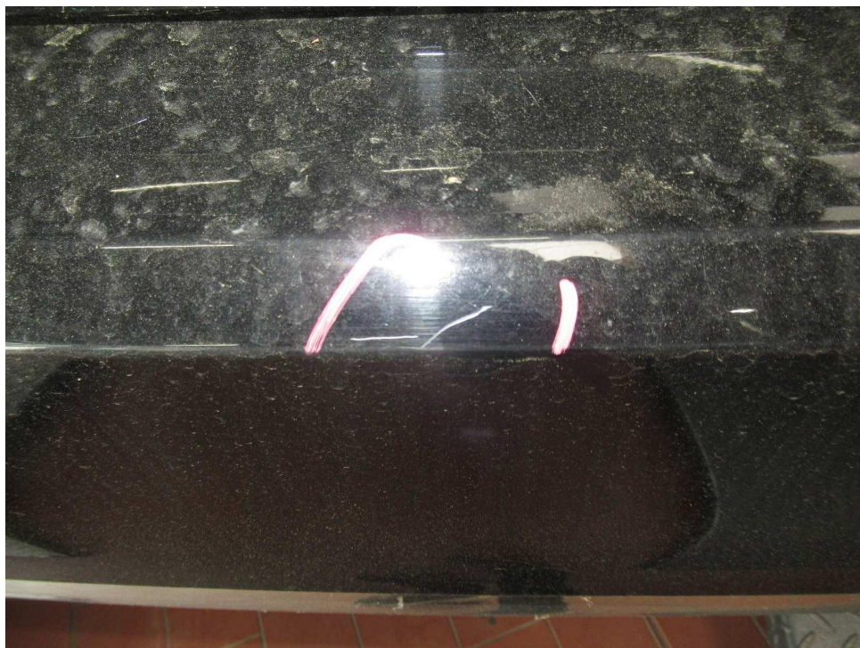
Bild 10 : Stoßfänger hinten zerkratzt
