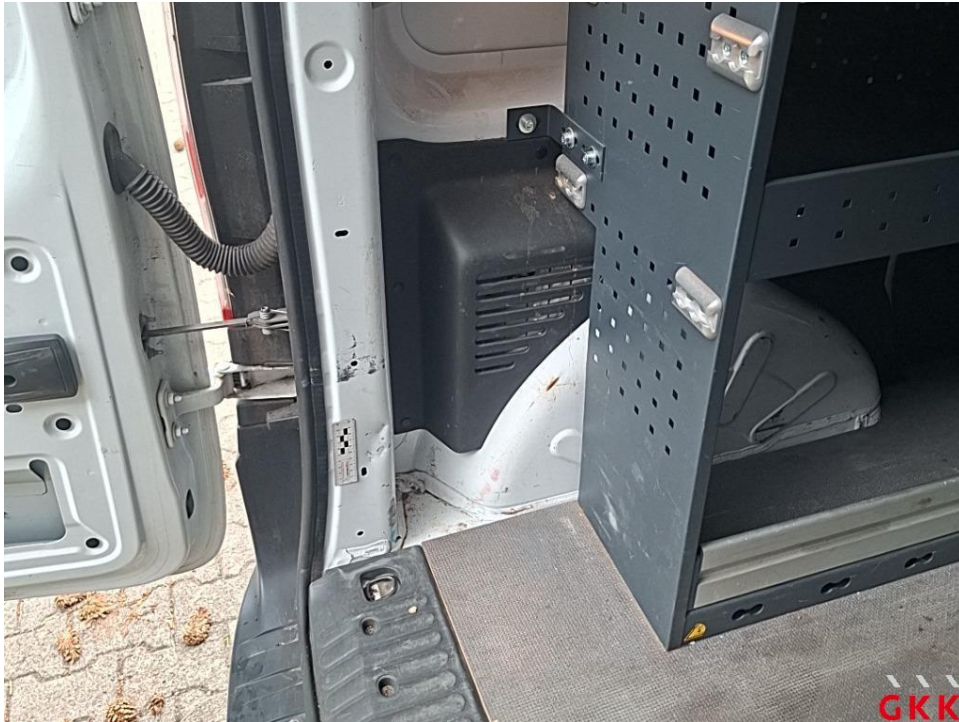
Bild 15. D- Säule links, beschädigt, instand setzen - lackieren
