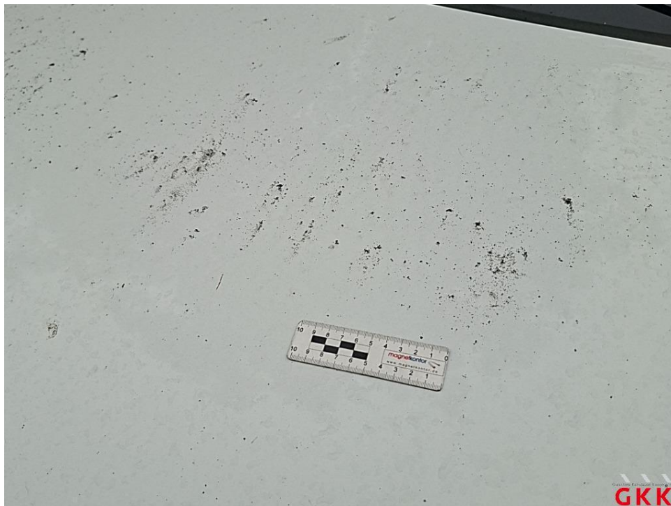
Bild 30. Motorhaube, Harzanhaftungen/-rückstände, aufbereiten
