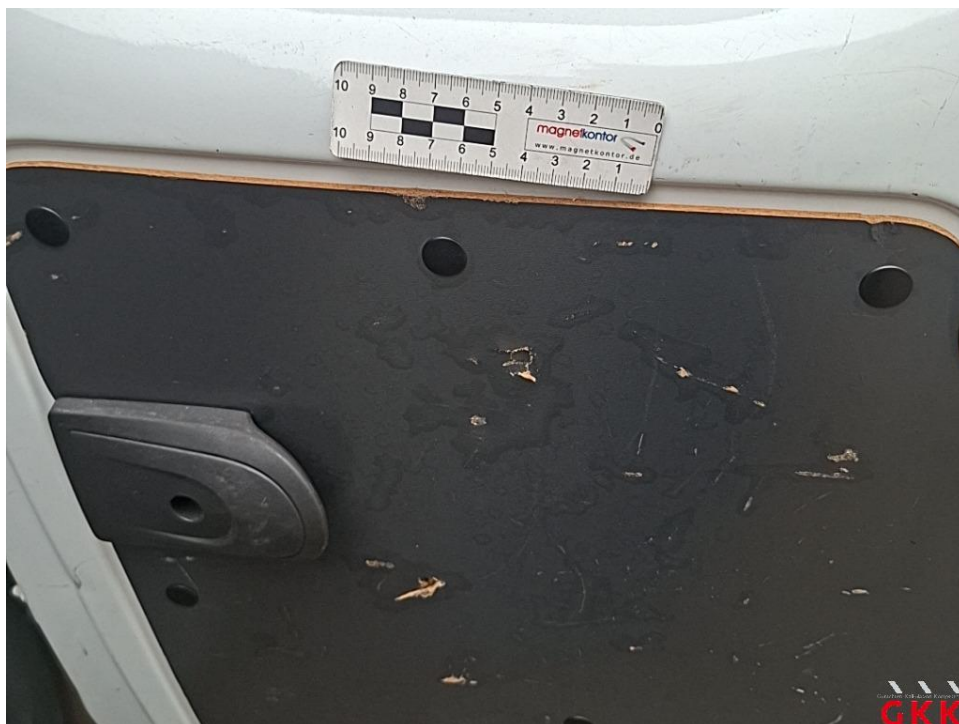
Bild 20. Hecktür rechts, Innenverkleidung, beschädigt, ersetzen
