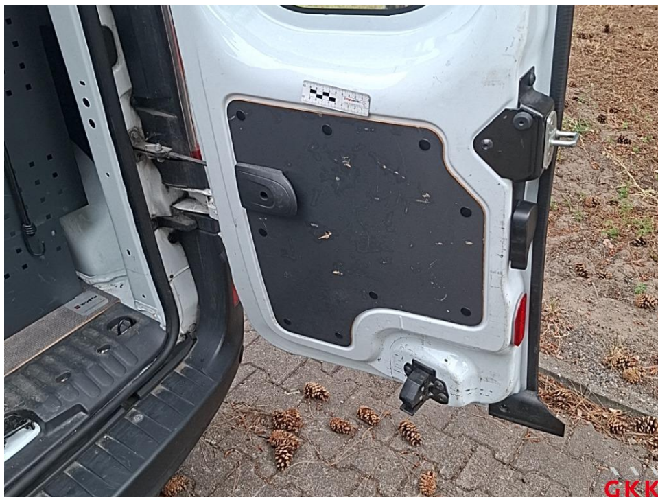
Bild 19. Hecktür rechts, Innenverkleidung, beschädigt, ersetzen
