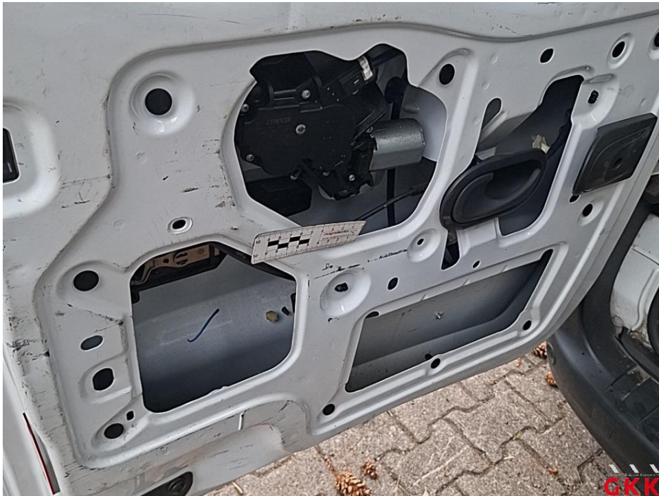
Bild 14. Hecktür links, Innenverkleidung, fehlt, ersetzen
