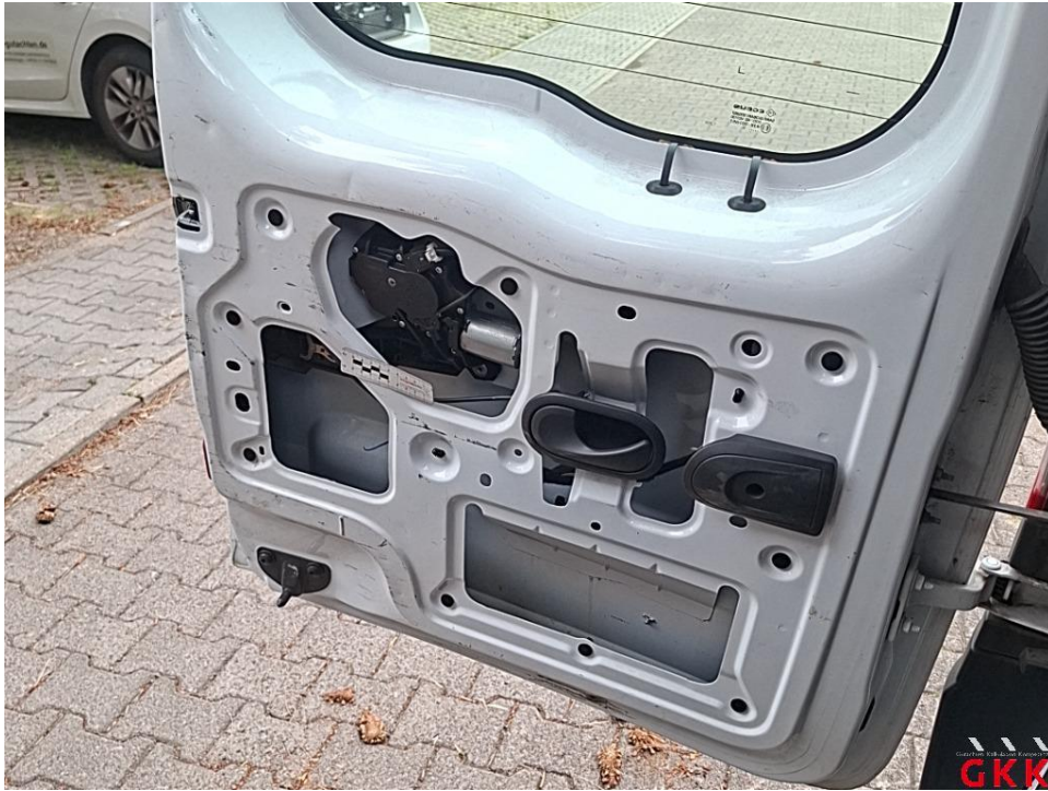
Bild 13. Hecktür links, Innenverkleidung, fehlt, ersetzen
