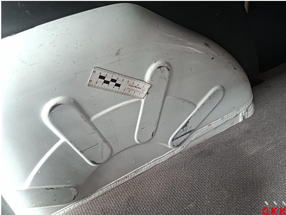
Bild 18. Radhaus hinten links, beschädigt, instand setzen - lackieren
