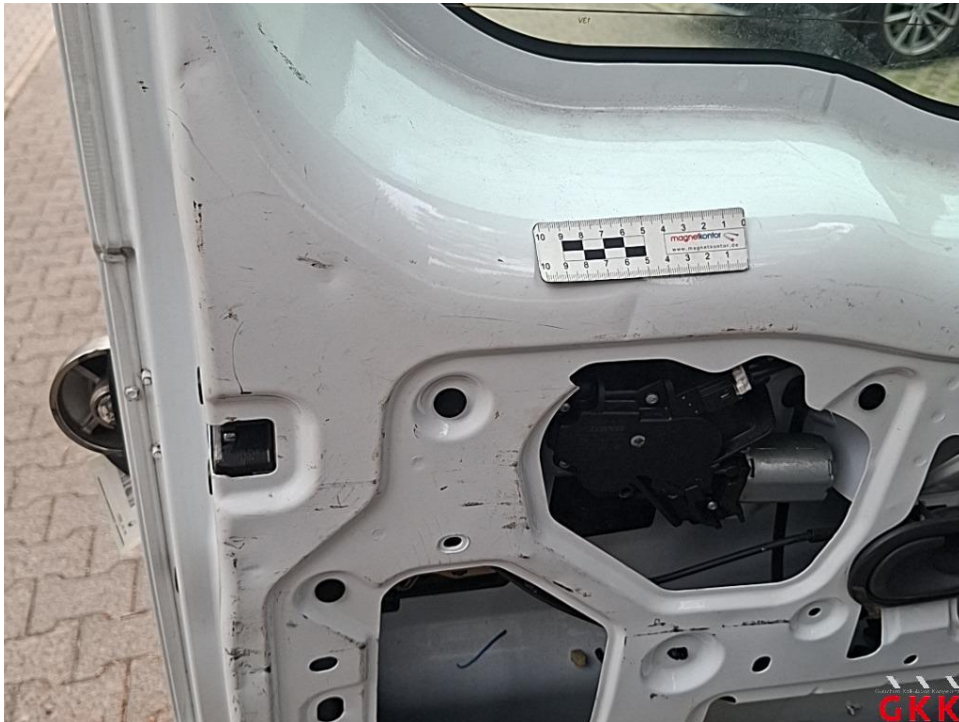
Bild 12. Hecktür links, innen, beschädigt, instand setzen - lackieren
