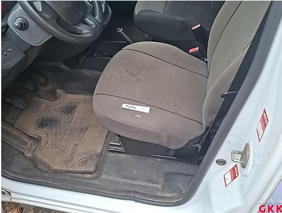
Bild 25. Sitz vorne links, Schonbezug, beschädigt, ersetzen
