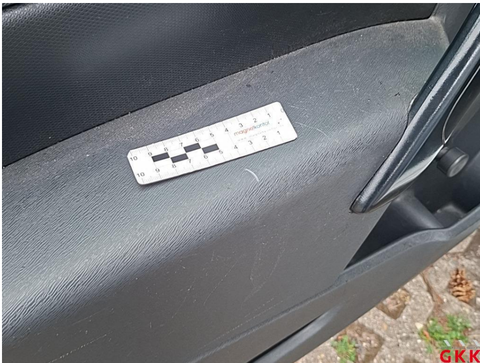
Bild 28. Tür vorne links, Innenverkleidung -Standard-, verkratzt, Smartrepair
