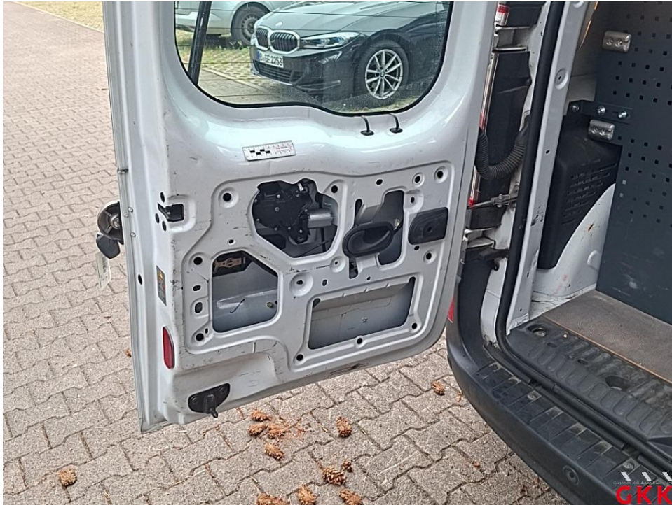
Bild 11. Hecktür links, innen, beschädigt, instand setzen - lackieren
