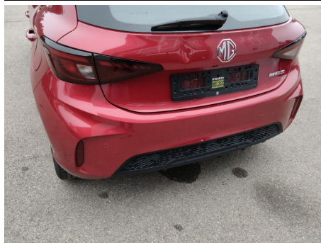
Stoßfänger / Hinten / Gebrochen
