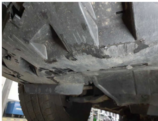
Beschädigung #2: Stossfänger vorn: Spoiler (Zusatzkosten möglich) - gebrochen / gerissen - erneuern
