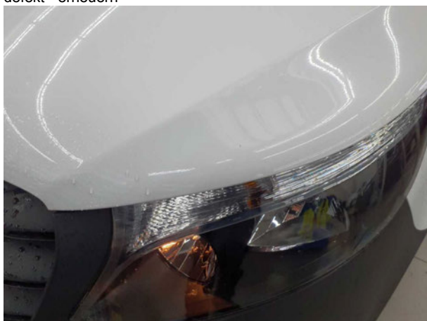
Beschädigung #3: Motorhaube: Motorhaube - Steinschlag - auslege... polieren
