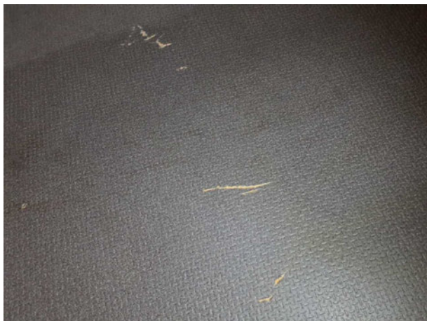
Beschädigung #10: Heckbereich: Holzboden hinten - Kratzer - Smart Repair
