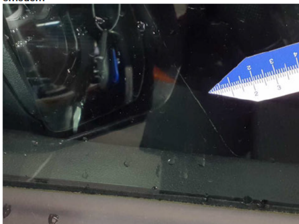
Beschädigung #7: Verglasung: Türscheibe vorn links - Kratzer - erneuern
