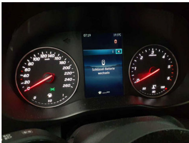
Beschädigung #1: elektrisches System: Batterie (Fahrzeugschlüssel... defekt - erneuern
