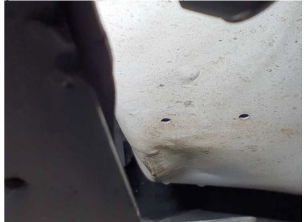
Beschädigung #15: Karosserie: Eckbeplankung unterhalb links - Delle / Lackschaden - instandsetzen/lackieren (S3)
