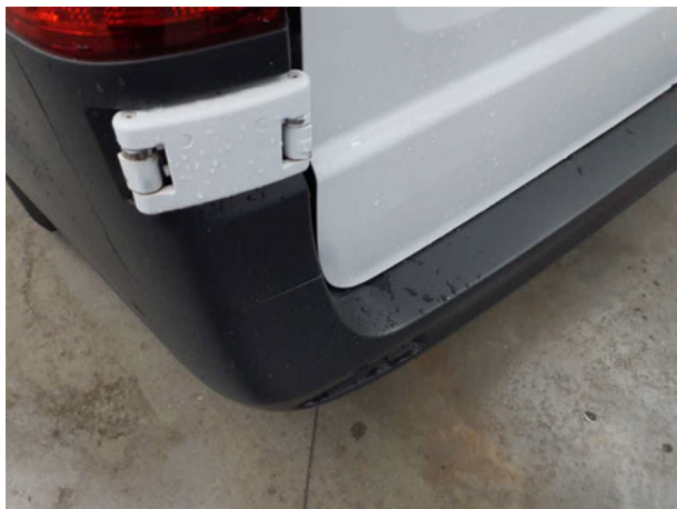
Beschädigung #12: Heckklappe/-tür: Hecktür links - Delle / Lackschaden - instandsetzen und lackieren
