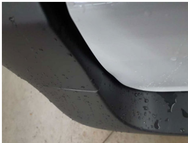
Beschädigung #12: Heckklappe/-tür: Hecktür links - Delle / Lackschaden - instandsetzen und lackieren
