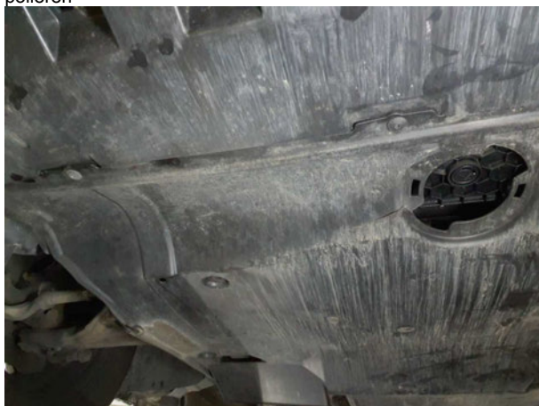
Beschädigung #6: Motor: Motorverkleidung unten (Zusatzkosten möglich) - gebrochen / gerissen - erneuern
