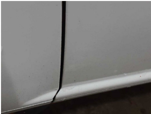
Beschädigung #13: Schiebetür rechts: Schiebetür - nicht fachgerecht instandgesetzt - instandsetzen und lackieren
