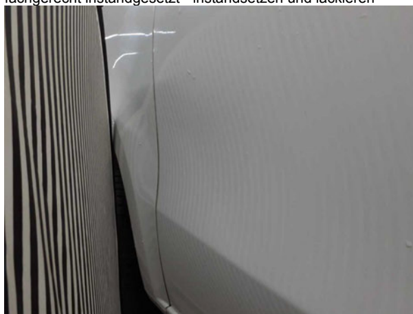
Beschädigung #13: Schiebetür rechts: Schiebetür - nicht fachgerecht instandgesetzt - instandsetzen und lackieren
