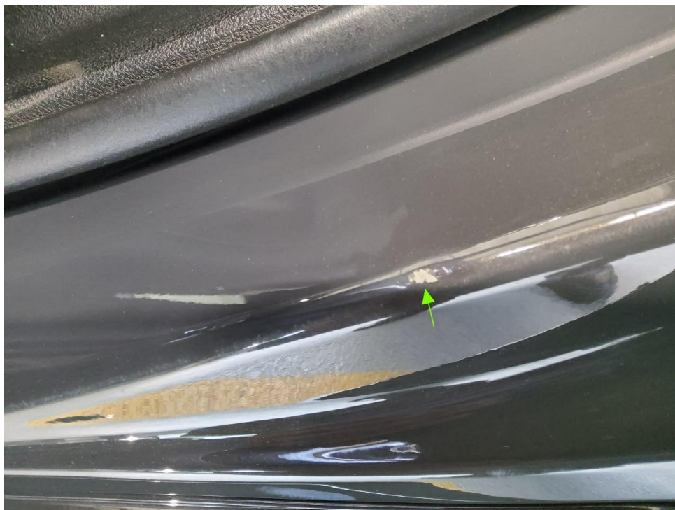
Bild 15 : Einstieg hinten links zerkratzt
