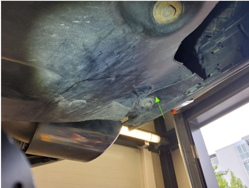
Bild 25 : Rückseite rechts Anfahrschaden
