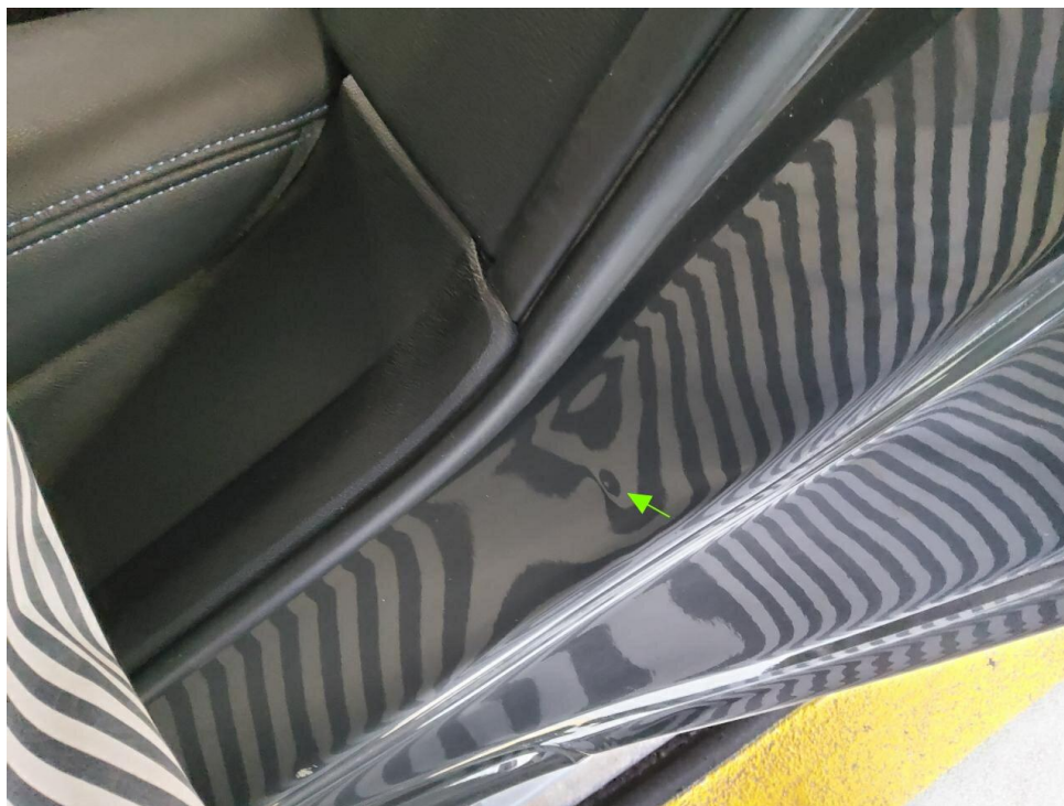
Bild 16 : Einstieg hinten links eingedellt
