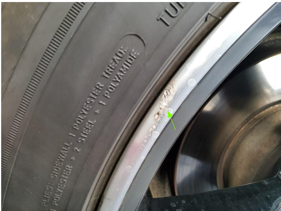
Bild 20 : Felge glanzgedreht vorne links zerkratzt
