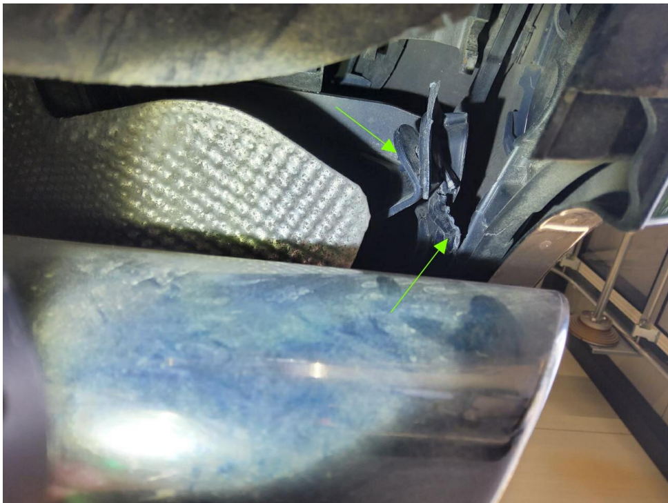
Bild 26 : Rückseite rechts Anfahrschaden
