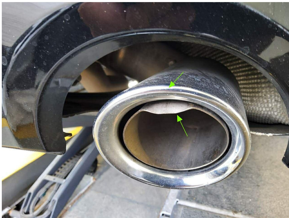
Bild 23 : Rückseite rechts Anfahrschaden
