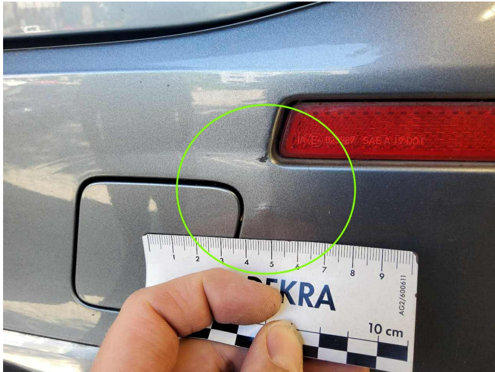
Bild 23 : Stoßfängerabdeckung hinten, verformt
