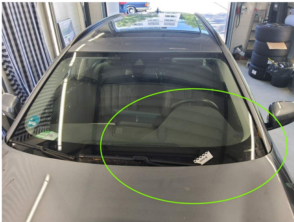
Bild 17 : Windschutzscheibe, Steinschlag mit Rissbildung
