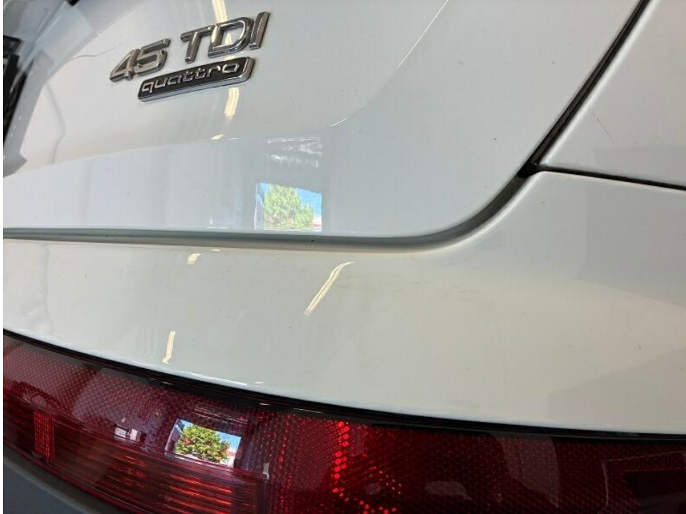
Bild 20 : Stoßfänger hinten Restreparaturspuren + Farbunterschied
