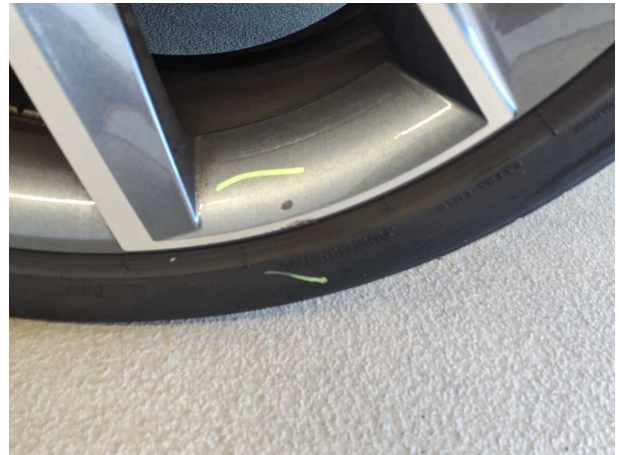
Beschädigung #3: Rad/Reifen: Leichtmetallfelge hinten links - verkratzt / verschürft - Wertminderung
