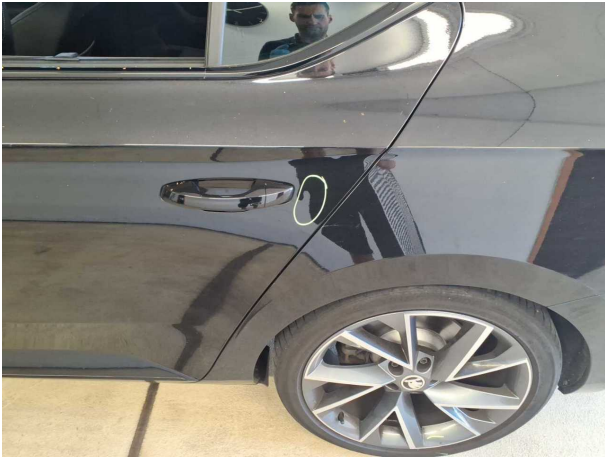
Beschädigung #1: Tür hinten links: Tür - Delle(n) - sanft instandsetzen
