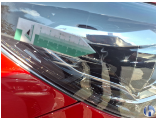
13. Scheinwerfer Halogen - Rechts Kratzer - Erneuern
