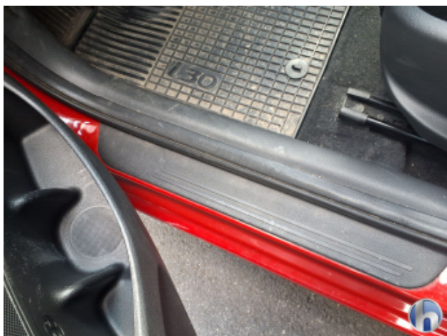
7. Verkleidung Verschmutzt - Reinigen
