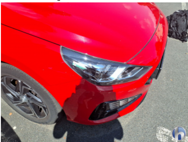
13. Scheinwerfer Halogen - Rechts Kratzer - Erneuern
