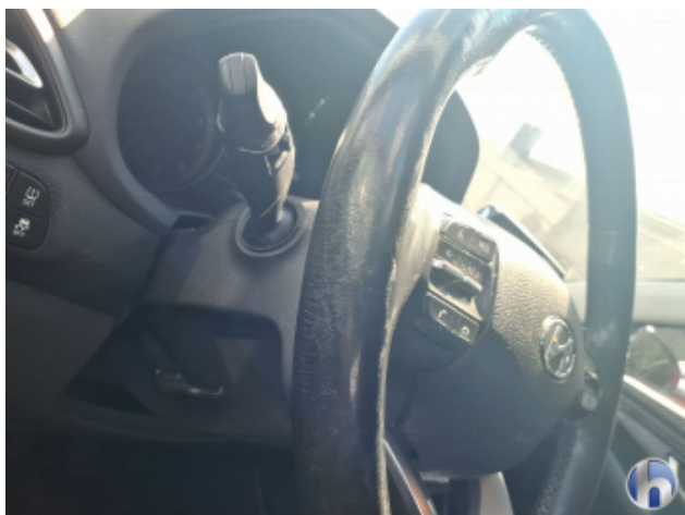
10. Lenkrad Beschädigt - Erneuern
