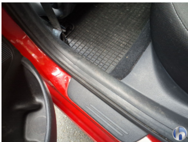
7. Verkleidung Verschmutzt - Reinigen
