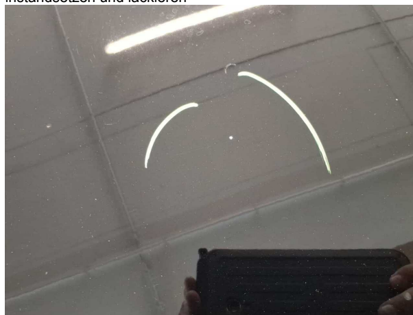
Beschädigung #3: Motorhaube: Motorhaube - Steinschlag - instandsetzen und lackieren
