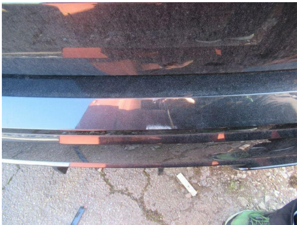
Bild 10 : Stossfängerverkleidung hinten verschrammt
