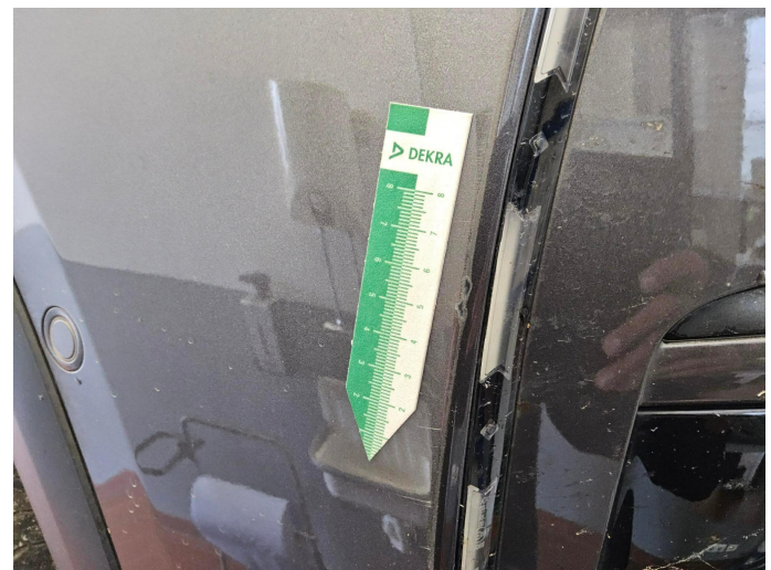
Bild 6: Außen, Stoßfänger vorne, verschrammt, lackieren mit Lackaufbau
