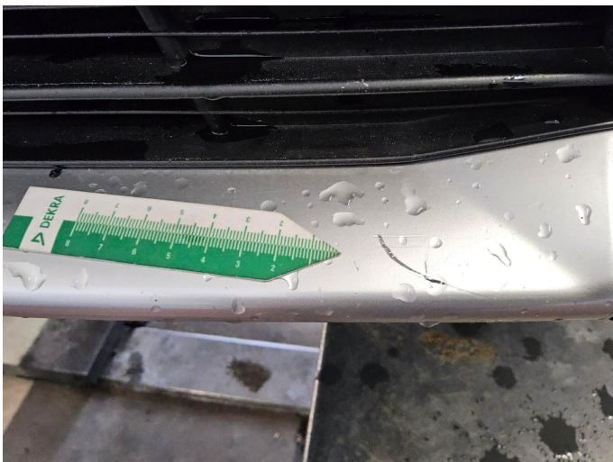
Bild 3: Außen, Frontspoiler, verschrammt, erneuern
