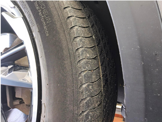
Bild 1: Technik, Reifen Vorderachse, außenseitiger Reifenverschleiß, erneuern
