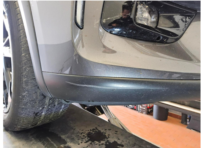
Bild 2: Außen, Frontspoiler, verschrammt, erneuern
