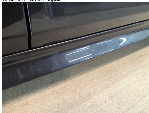
Beschädigung #5: Schweller rechts: Verkleidung - verkratzt / verschürft - Wertminderung
