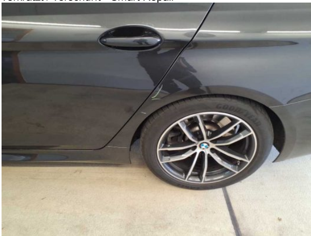
Beschädigung #8: Seitenwand links: Seitenwand - verkratzt / verschürft - Smart Repair
