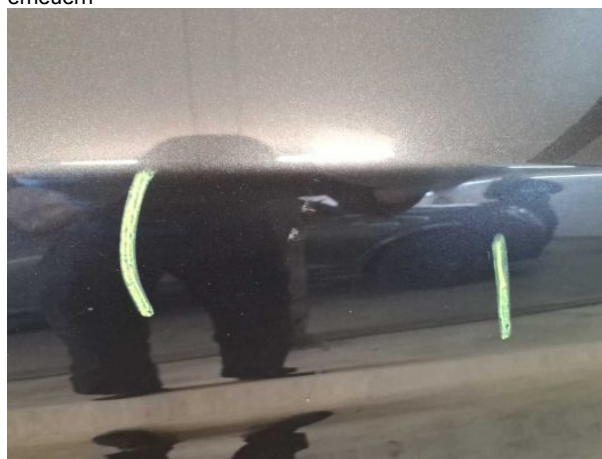
Beschädigung #11: Tür vorn rechts: Tür - verkratzt / verschürft - instandsetzen und lackieren
