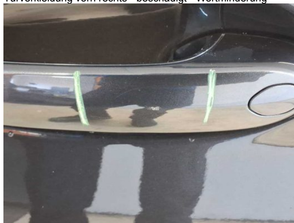
Beschädigung #3: Tür vorn links: Griff außen - verkratzt / verschürft - Smart Repair
