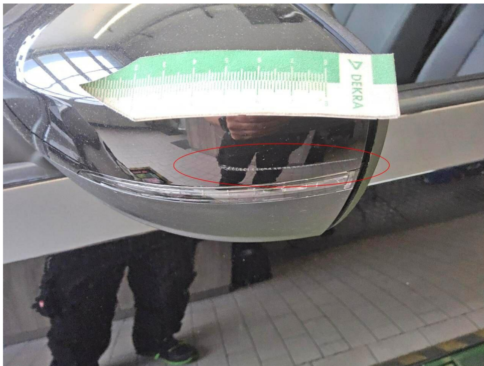
Bild 25 : Außenspiegel links Lackierung, verschrammt, Gebrauchsspur
