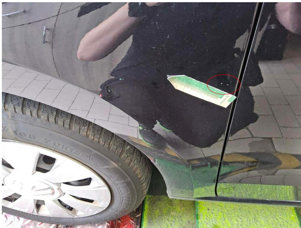
Bild 26 : Kotflügel vorne links Lackierung, Steinschlag, Gebrauchsspur
