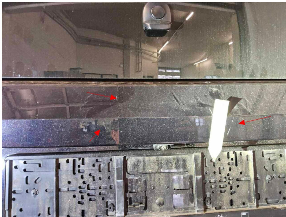
Bild 20 : Stoßfänger hinten Lackierung, verschrammt, Gebrauchsspur
