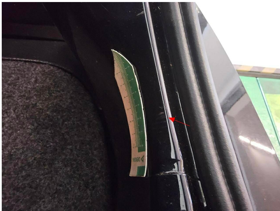
Bild 23 : Ladekantenabdeckung, verschrammt, Gebrauchsspur
