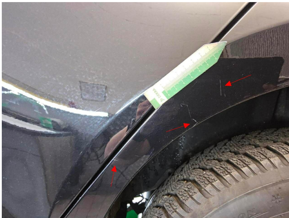
Bild 21 : Seitenteil hinten links Lackierung unterhalb, verschrammt, Gebrauchsspur
