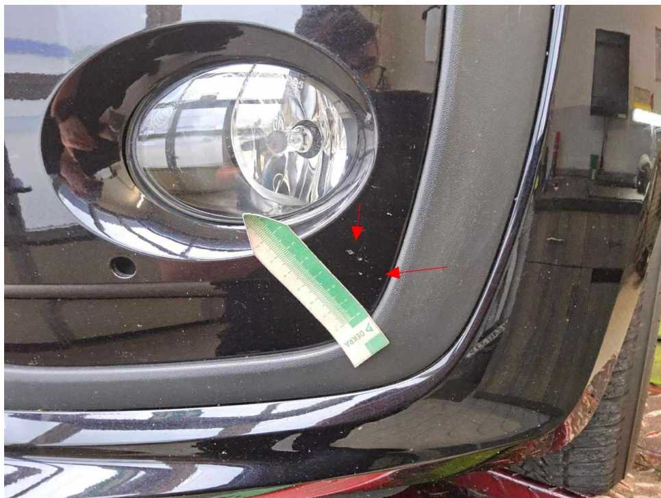
Bild 22 : Stoßfänger vorne Lackierung, Steinschlag, Gebrauchsspur
