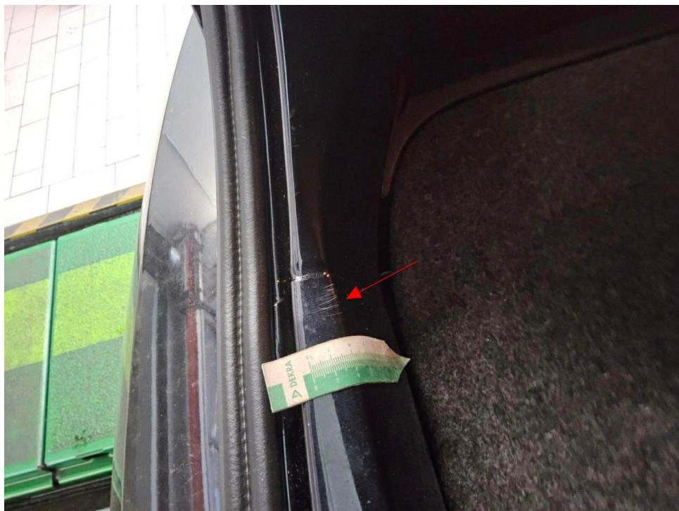
Bild 24 : Ladekantenabdeckung, verschrammt, Gebrauchsspur
