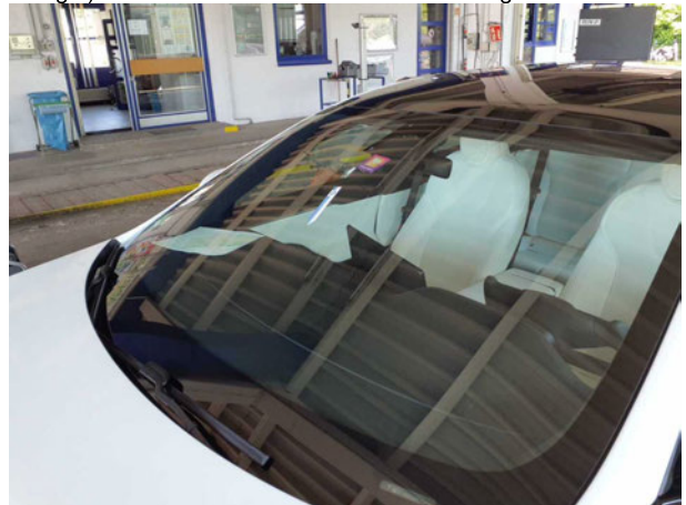
Beschädigung #7: Verglasung: Frontscheibe (Mit Rissbildung) - Steinschlag - erneuern
