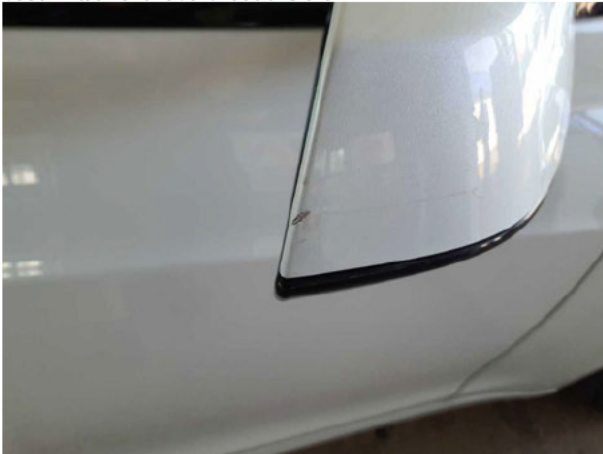
Beschädigung #2: Außenspiegel rechts: Abdeckkappe - verkratzt / verschürft - lackieren
