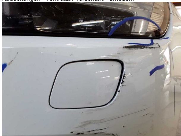
Beschädigung #7: Verkleidungen/Abdeckungen: Verkleidungen/Abdeckungen - lose - erneuern
