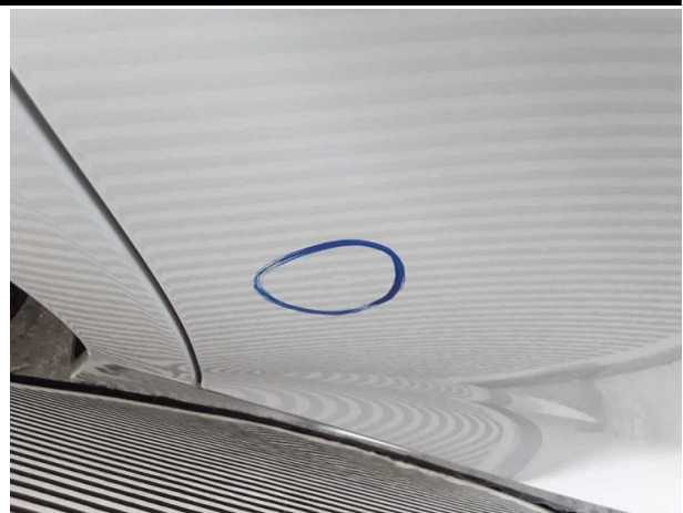
Beschädigung #8: Tür hinten rechts: Tür - Delle / Lackschaden - Smart Repair
