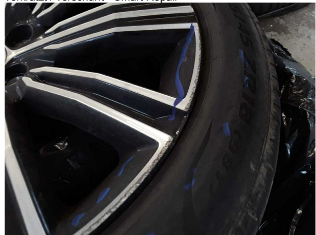
Beschädigung #11: 2.Radsatz: 2 Leichtmetallfelgen - verkratzt / verschürft - Wertminderung
