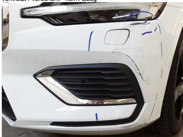
Beschädigung #6: Verkleidungen/Abdeckungen: Verkleidungen/Abdeckungen - verkratzt / verschürft - erneuern
