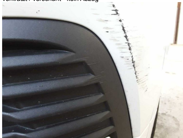
Beschädigung #6: Verkleidungen/Abdeckungen: Verkleidungen/Abdeckungen - verkratzt / verschürft - erneuern
