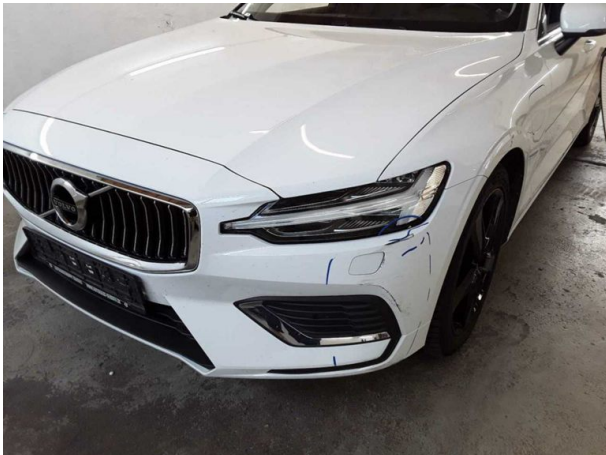
Beschädigung #13: Scheinwerfer: LED-Scheinwerfer links - verkratzt / verschürft - erneuern
