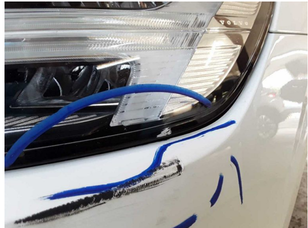
Beschädigung #13: Scheinwerfer: LED-Scheinwerfer links - verkratzt / verschürft - erneuern
