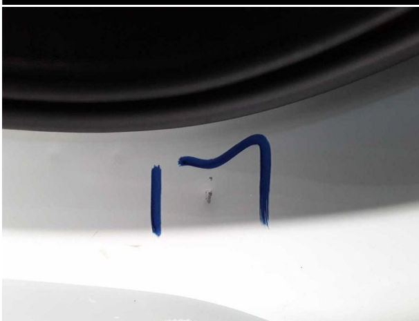
Beschädigung #12: Seitenwand links: Einstieg - Delle / Lackschaden - instandsetzen und lackieren
