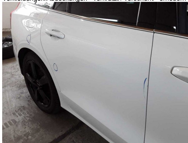
Beschädigung #8: Tür hinten rechts: Tür - Delle / Lackschad... - Smart Repair
