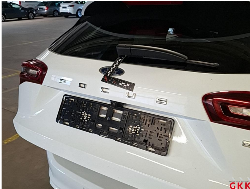
Bild 20 Heckklappe, beschädigt, kalt drücken
