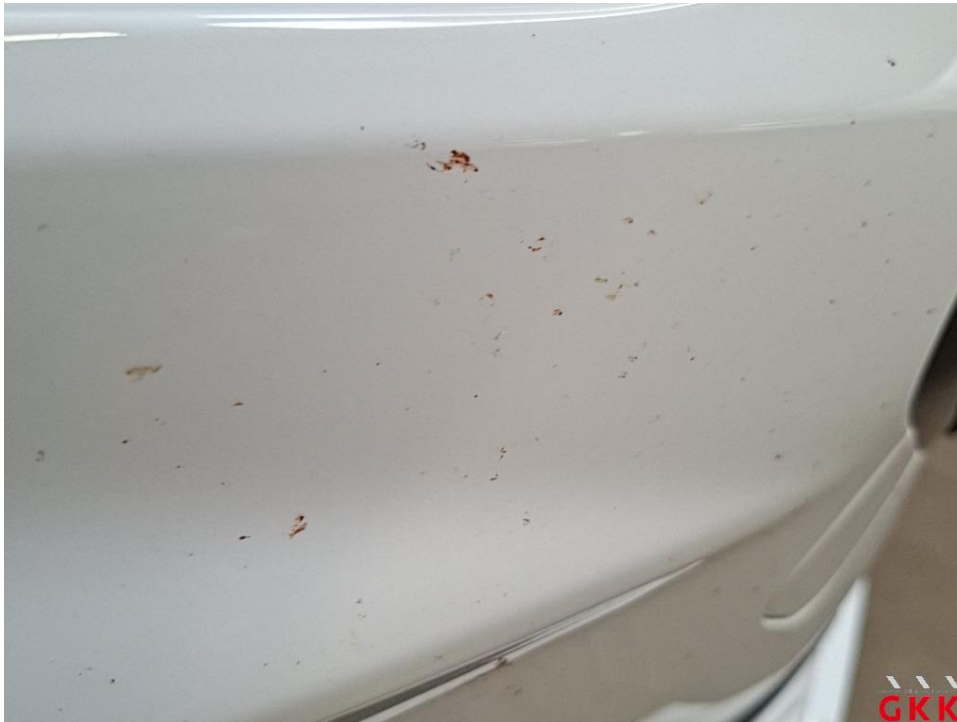
Bild 17 Fahrzeug, außen, Lackierung verwittert / matt, aufbereiten
