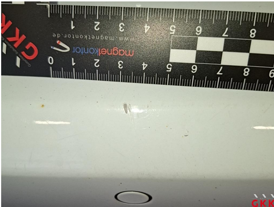
Bild 24 Stoßfänger hinten, Verkleidung -lackiert-, verkratzt, Smartrepair
