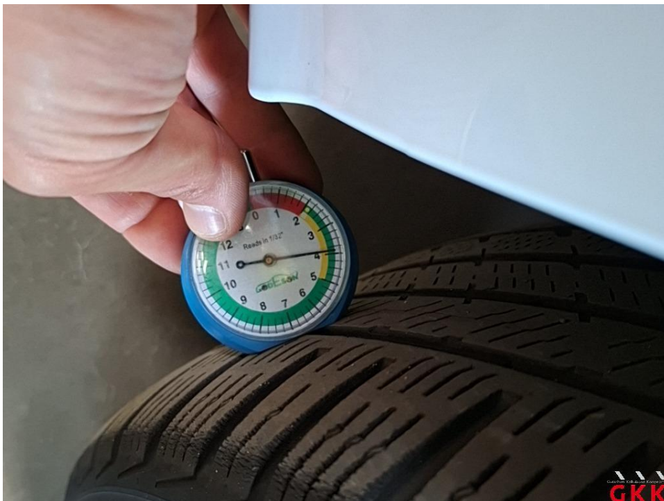
Bild 14 Reifen, vorn links und rechts, Untermaß, ersetzen
