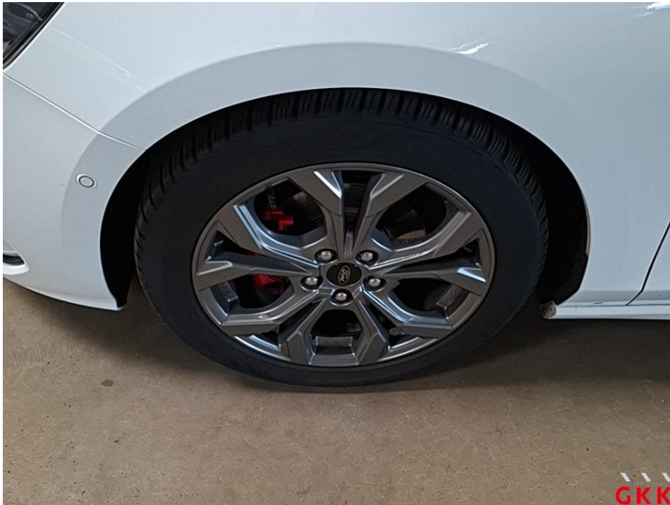
Bild 15 Reifen, vorn links und rechts, Untermaß, ersetzen
