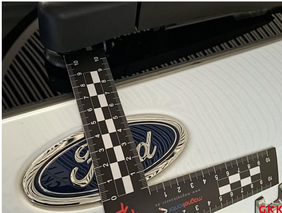
Bild 22 Heckklappe, beschädigt, kalt drücken
