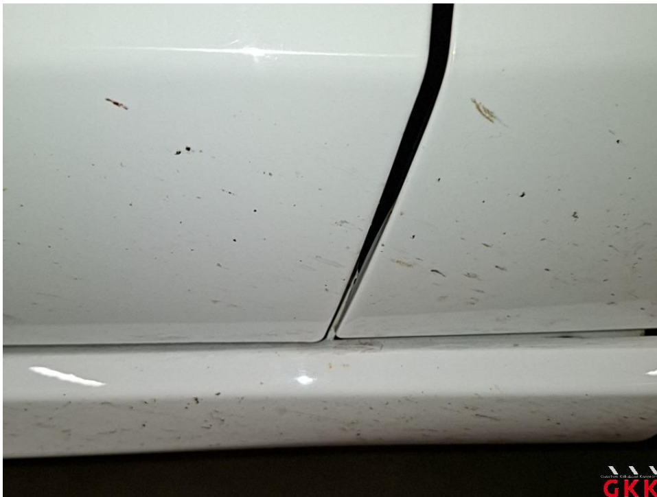
Bild 18 Fahrzeug, außen, Lackierung verwittert / matt, aufbereiten
