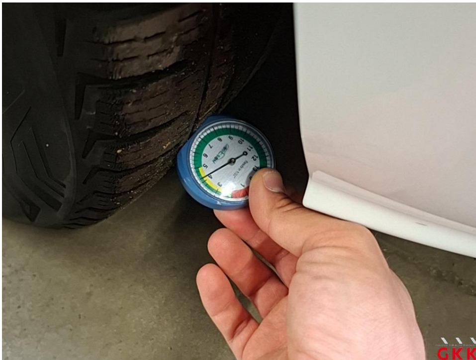
Bild 16 Reifen, vorn links und rechts, Untermaß, ersetzen
