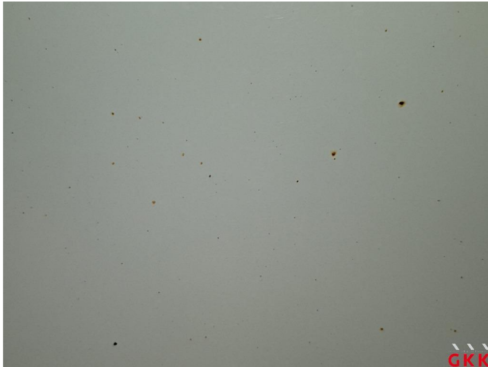
Bild 19 Fahrzeug, außen, Lackierung verwittert / matt, aufbereiten
