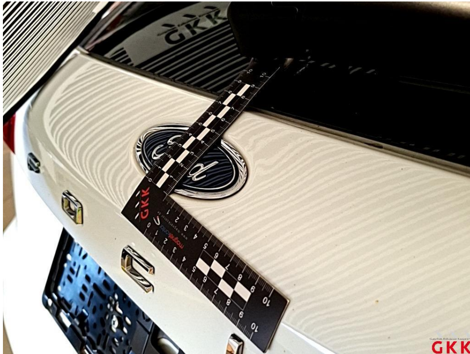
Bild 21 Heckklappe, beschädigt, kalt drücken
