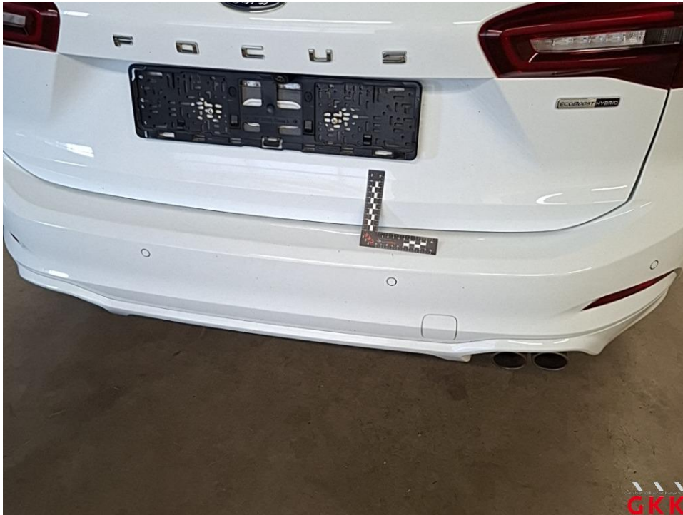
Bild 23 Stoßfänger hinten, Verkleidung -lackiert-, verkratzt, Smartrepair
